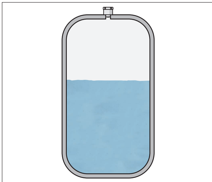
Fig. 14: Mesure de niveau avec VEGAPULS Air 41 dans la cuve de liquide
