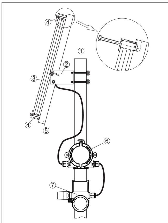
Fig. 13: Montage sur tuyauterie PLICSMOBILE avec module solaire
