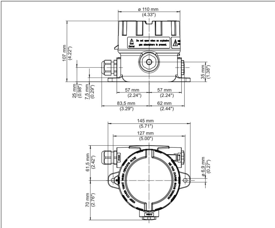
Fig. 21: Dimensions PLICSMOBILE B81 avec boîtier aluminium
