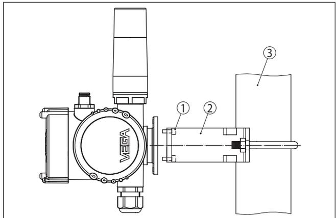
Fig. 4: PLICSMOBILE T81 pour montage sur tuyauterie
