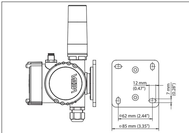
Fig. 2: PLICSMOBILE T81 pour montage mural. Plaque de montage vue de dessous.
