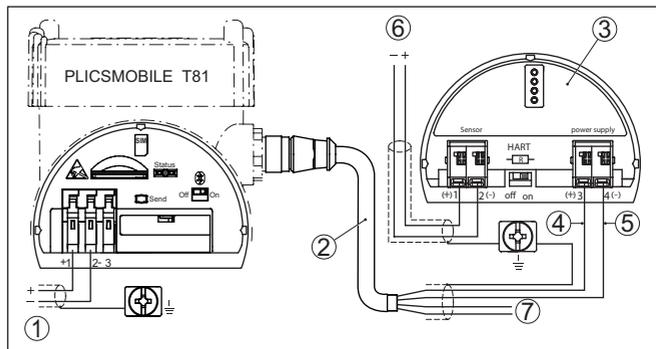
Fig. 8: Raccordement de l'alimentation tension et du VEGADIS 82 HART
