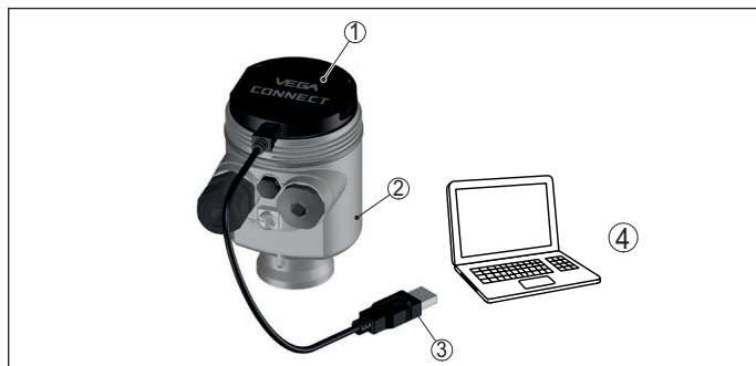
Abb. 23: Anschluss des PCs via VEGACONNECT und USB
