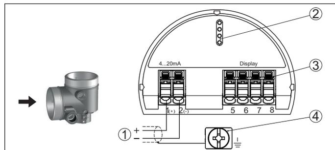
Fig. 6: Compartiment de raccordement - boîtier à deux chambres
