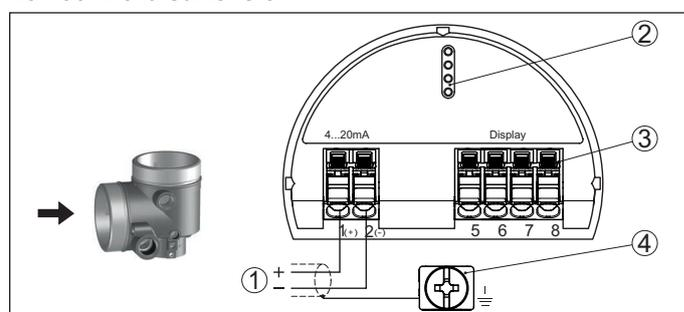
Fig. 7: Compartiment de raccordement - boîtier à deux chambres
