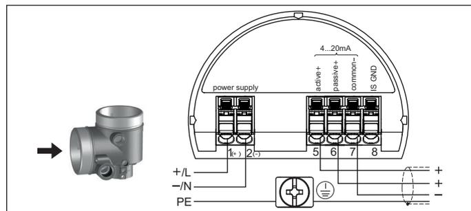
Fig. 14: Compartiment de raccordement boîtier deux chambres - tension réseau
