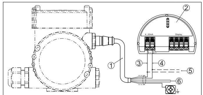
Fig. 11: Raccordement d'autres capteurs plics®
