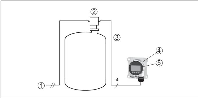
Fig. 26: Raccordement du VEGADIS 81 au capteur
