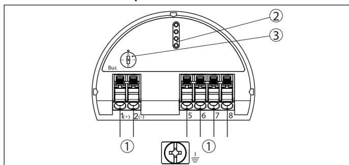
Fig. 18: Compartiment électronique et de raccordement - boîtier à chambre unique
