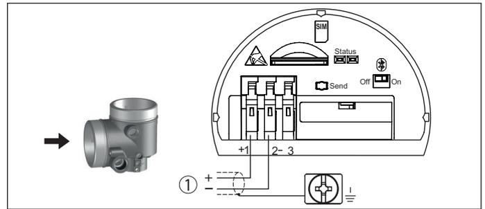
Fig. 10: Compartiment de raccordement - Module radio PLICSMOBILE 81
