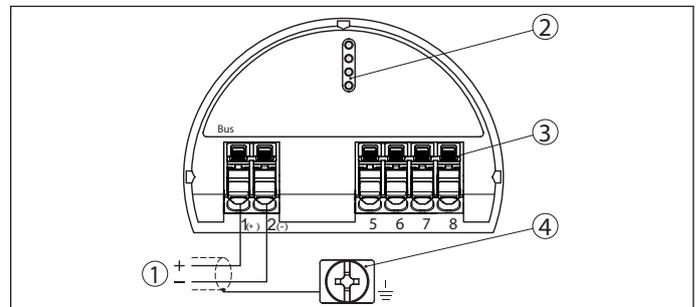
Fig. 17: Compartiment de raccordement boîtier à deux chambres
