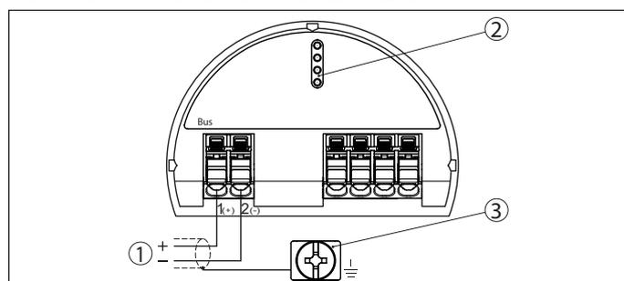
Fig. 20: Compartiment de raccordement - boîtier à deux chambres
