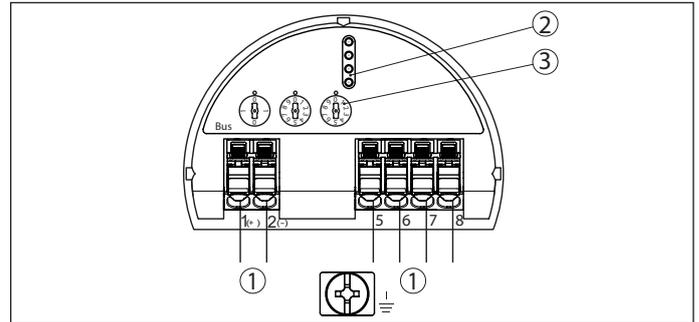
Fig. 16: Compartiment électronique - boîtier à deux chambres
