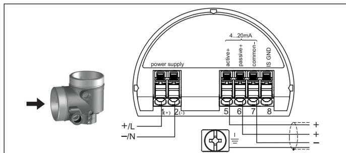
Fig. 13: Compartiment de raccordement boîtier deux chambres - très basse tension
