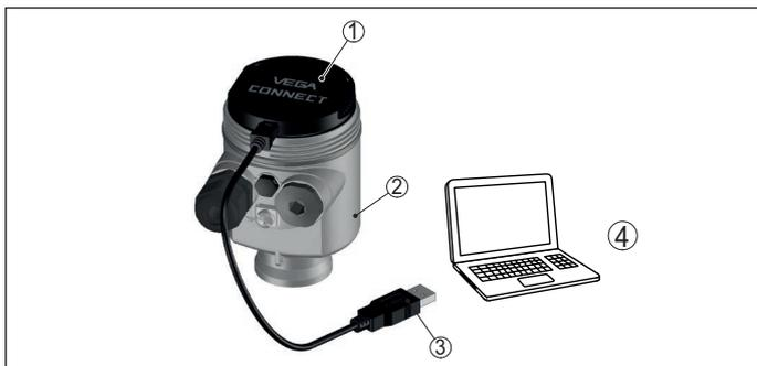
Fig. 20: Raccordement du PC via VEGACONNECT et USB
