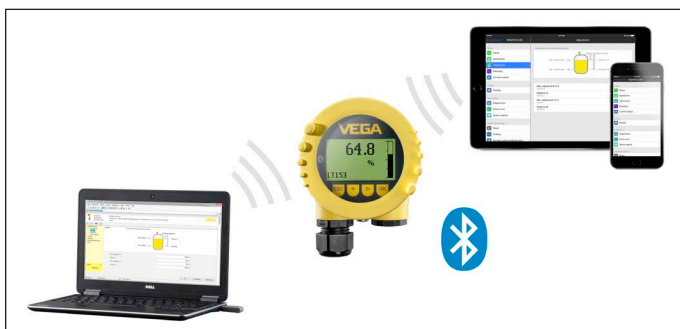
Fig. 1: Draadloze verbinding met standaard verbindingen
