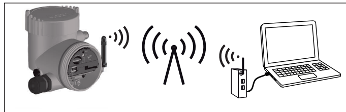
Rys. 29: Transmisja bezprzewodowa wartości pomiarowych i zdalne wprowadzanie parametrów do przyrządu za pośrednictwem sieci bezprzewodowej GSM
