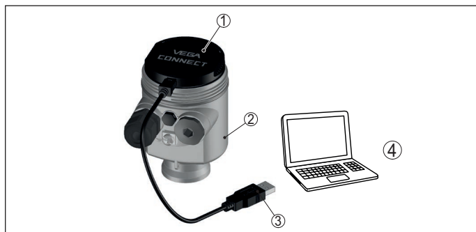
Rys. 23: Podłączenie PC poprzez VEGACONNECT i USB
