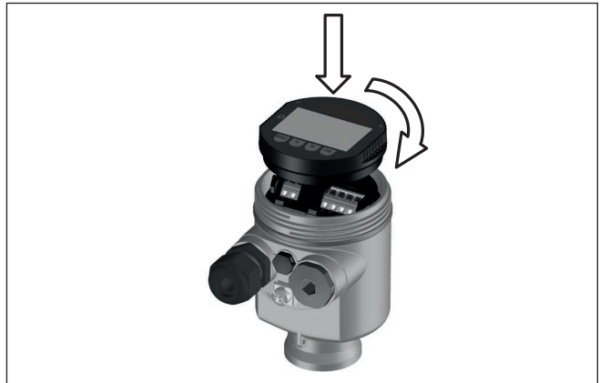
Fig. 9: Montage du module d'affichage et de réglage dans le boîtier à chambre unique se trouvant dans le compartiment de l'électronique
