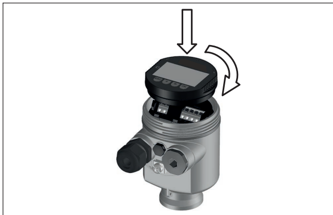
Fig. 7: Plaatsen van de display- en bedieningsmodule bij eenkamerbehuizing in elektronicaruimte.
