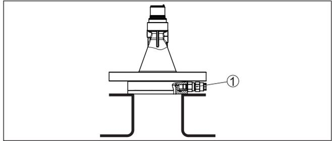
Abb. 39: Kunststoff-Hornantenne mit Überwurfanschlag
