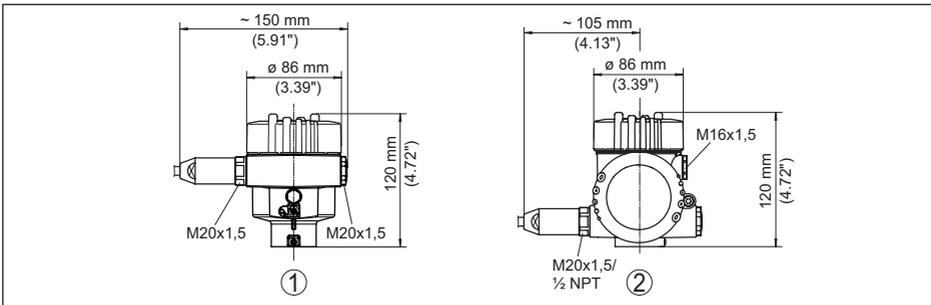
Abb. 79: Gehäuseausführungen in Schutzart IP66/IP68 (1 bar), (mit eingebautem Anzeige- und Bedienmodul vergrößert sich die Gehäusehöhe um 18 mm/0.71 in)
