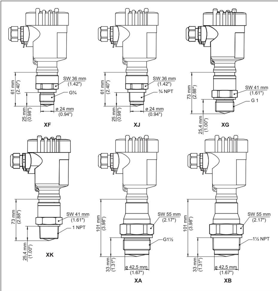
Abb. 87: VEGAPULS 6X, Gewinde mit integriertem Antennensystem bis +150 °C (+302 °F)
