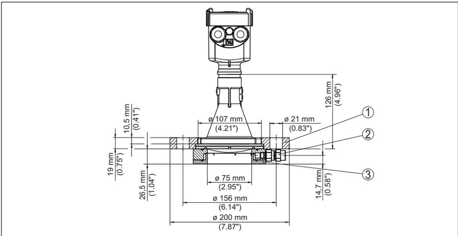
Abb. 83: Radarsensor mit Überwurfflansch und Spülluftanschluss passend für 3" 150 lbs, DN 80 PN 16
