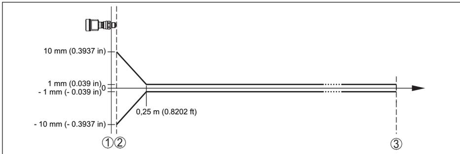
Abb. 65: Messabweichung unter Referenzbedingungen (Beispiel Gewinde mit integriertem Antennensystem, gilt entsprechend für alle Ausführungen außer Flansch mit Linsenantenne)
