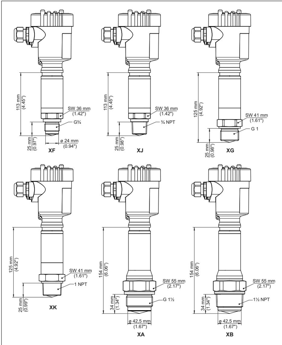
Abb. 88: VEGAPULS 6X, Gewinde mit integriertem Antennensystem bis +250 °C (+482 °F)
