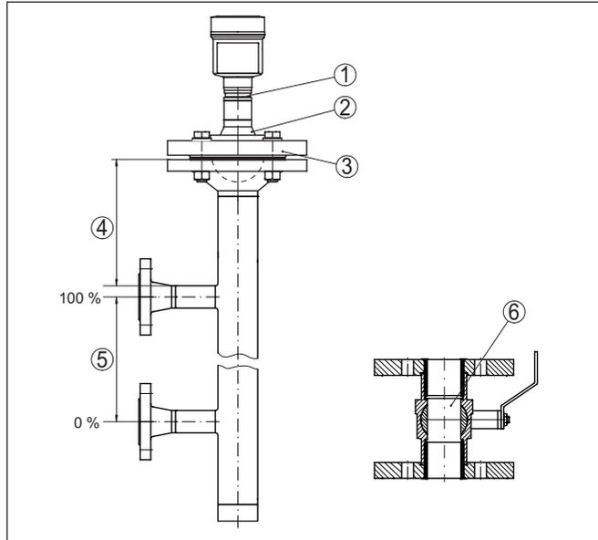
Abb. 41: Aufbau Bypass
