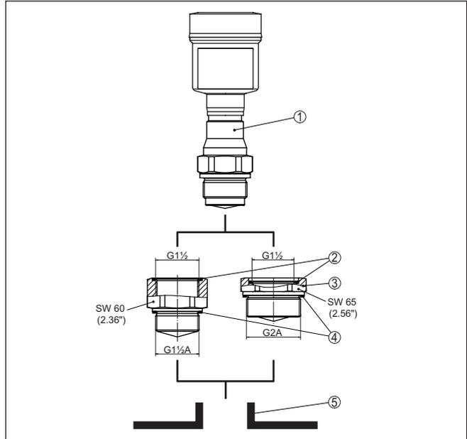
Abb. 27: VEGAPULS 6X mit PTFE-Gewindeadapter
