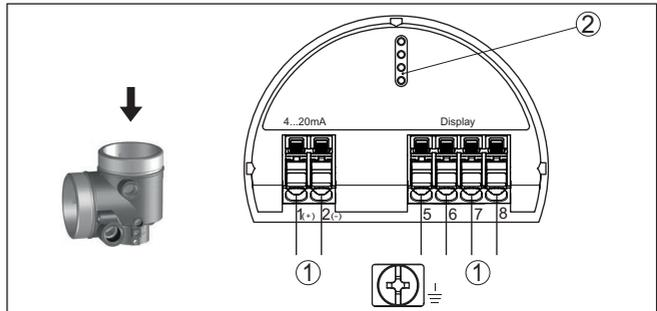
Abb. 46: Elektronikraum - Zweikammergehäuse
