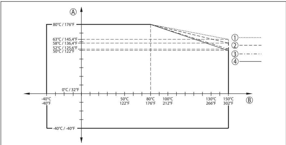
Abb. 74: Derating Umgebungstemperatur, Flansch mit Linsenantenne bis +150 °C (+302 °F)
