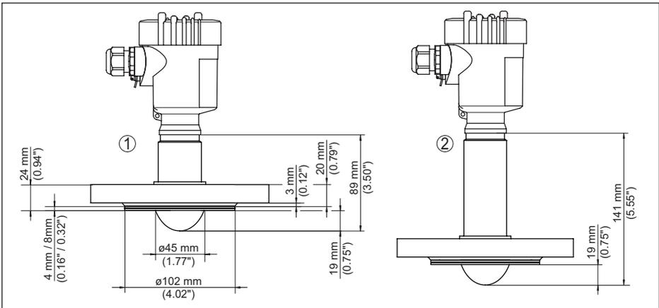
Abb. 90: VEGAPULS 6X, gekapseltes Antennensystem DN 50 PN 40
