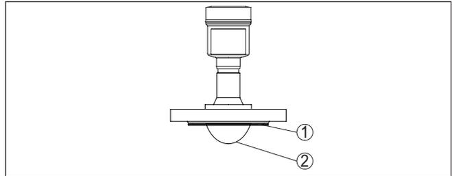
Abb. 24: VEGAPULS 6X mit Flansch und gekapseltem Antennensystem
