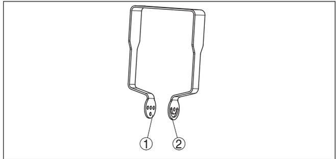
Abb. 6: Montagebügel zum Anschrauben an den Sensor
