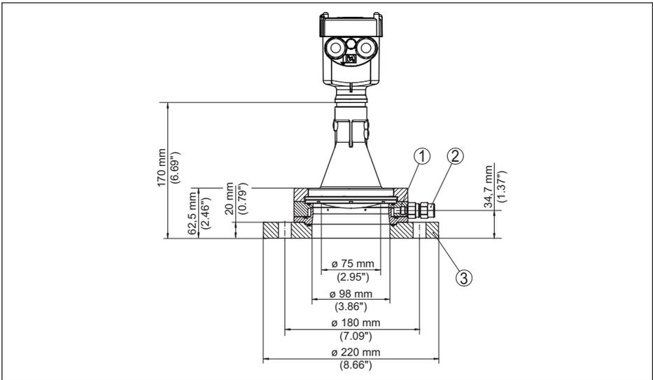
Abb. 85: VEGAPULS 6X, Adapterflansch und Spülluftanschluss DN 100 PN 6
