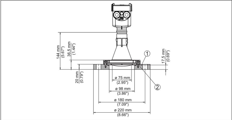
Abb. 84: Radarsensor mit Adapterflansch DN 100 PN 6
