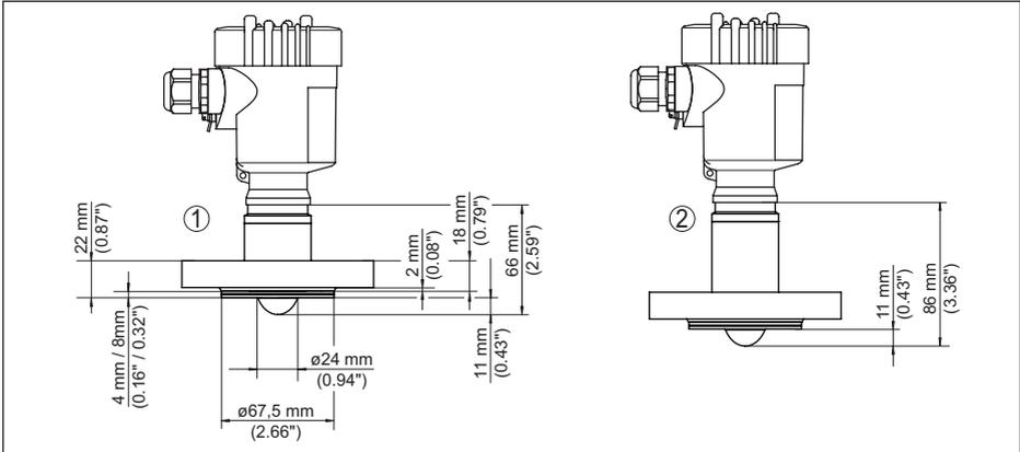
Abb. 89: VEGAPULS 6X, gekapseltes Antennensystem DN 25 PN 40
