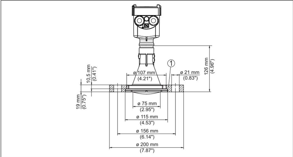
Abb. 82: Radarsensor mit Überwurfflansch passend für 3" 150 lbs, DN 80 PN 16
