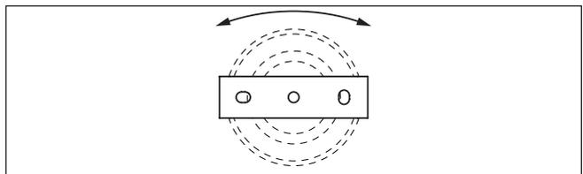
Abb. 8: Drehen bei Befestigung in der Mitte
