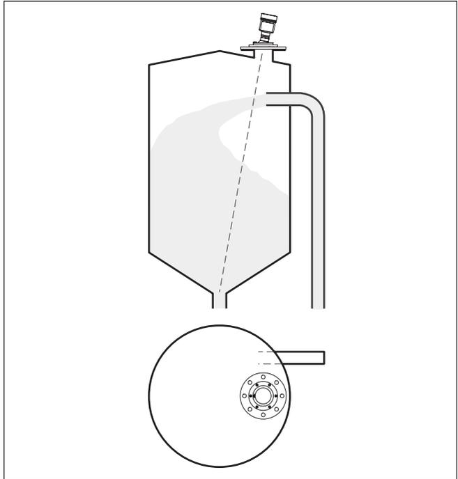
Abb. 21: Montage des Radarsensors bei einströmendem Medium
