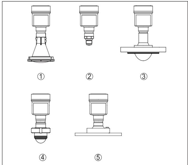
Abb. 2: Antennensysteme VEGAPULS 6X
