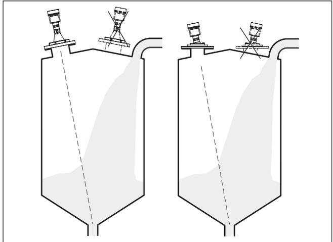
Abb. 20: Montage des Radarsensors bei einströmendem Medium
