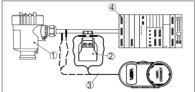
Abb. 60: Anschluss des PCs via HART an die Signalleitung
