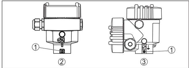
Abb. 4: Position der Arretierschraube je nach Gehäuse
