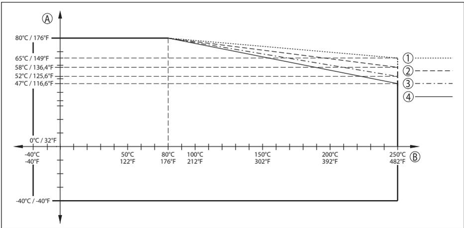
Abb. 76: Derating Umgebungstemperatur, Flansch mit Linsenantenne bis +250 °C (+482 °F)
