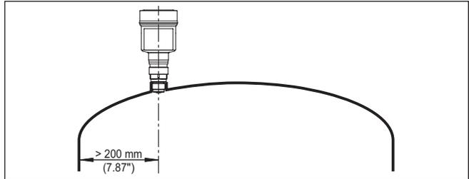
Abb. 15: Montage des Radarsensors an runden Behälterdecken
