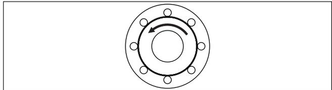
Abb. 26: VEGAPULS 6X - Losdrehen der PTFE-Scheibe
