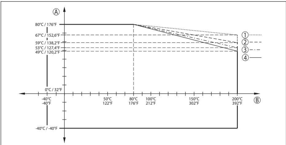
Abb. 69: Derating Umgebungstemperatur, Gewinde mit integriertem Antennensystem bis +200 °C (+392 °F)
