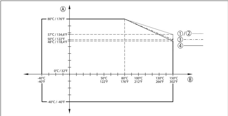
Abb. 71: Derating Umgebungstemperatur, Flansch mit Kunststoffplattierung, Hygieneanschluss bis +150 °C (+302 °F)
