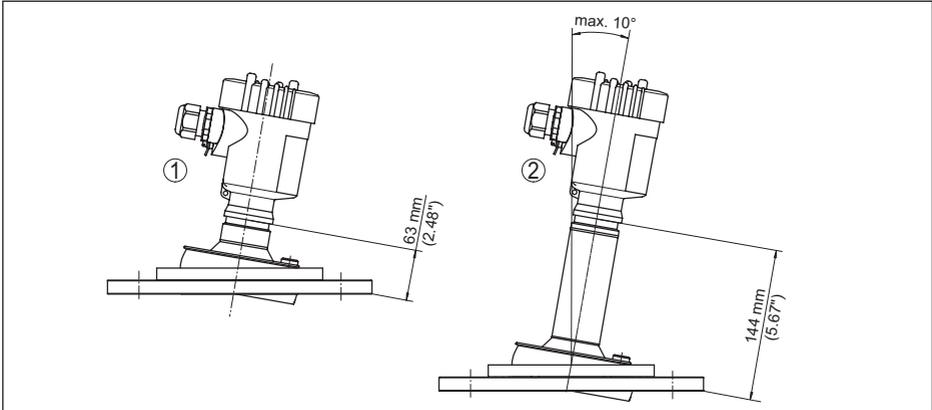
Abb. 95: VEGAPULS 6X, Flansch mit Linsenantenne und Schwenkhalterung
