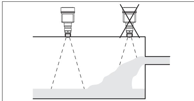
Abb. 19: Montage des Radarsensors bei einströmendem Medium
