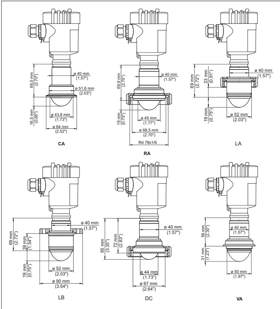
Abb. 92: VEGAPULS 6X, Hygieneanschluss
