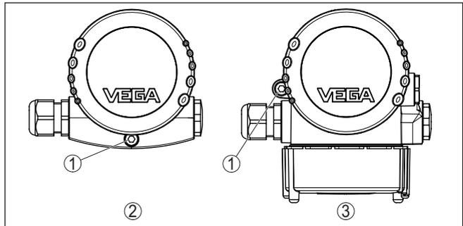
Abb. 5: Position der Sicherungsschraube je nach Gehäuse
