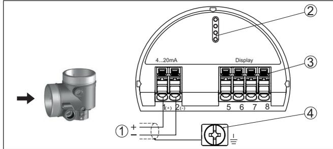
Abb. 47: Anschlussraum - Zweikammergehäuse
