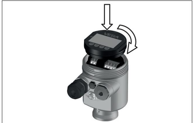
Abb. 49: Einsetzen des Anzeige- und Bedienmoduls beim Einkammergehäuse im Elektronikraum
