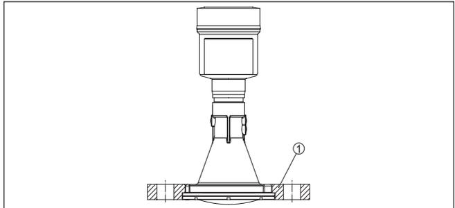
Abb. 12: Kombi-Überwurfflansch
