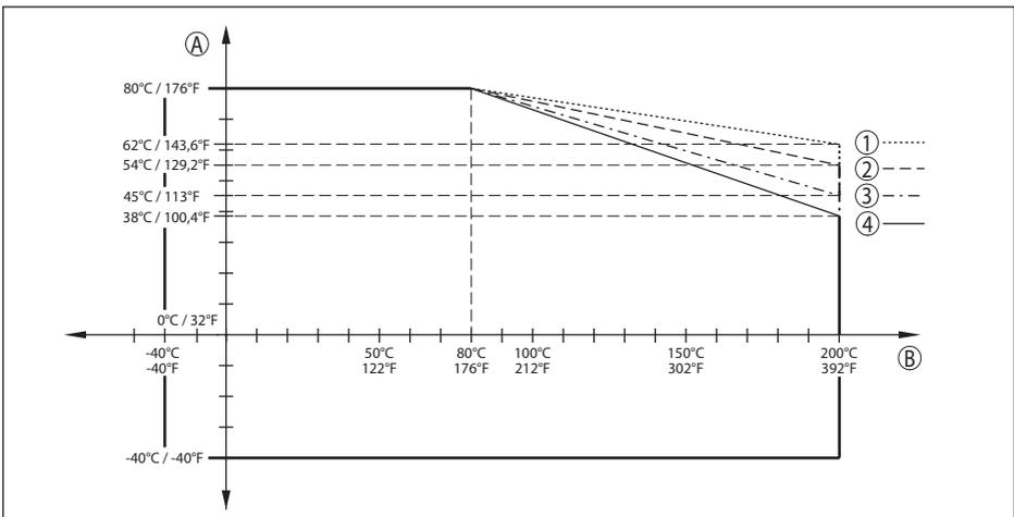
Abb. 72: Derating Umgebungstemperatur, Flansch mit Kunststoffplattierung bis +200 °C (+392 °F)
