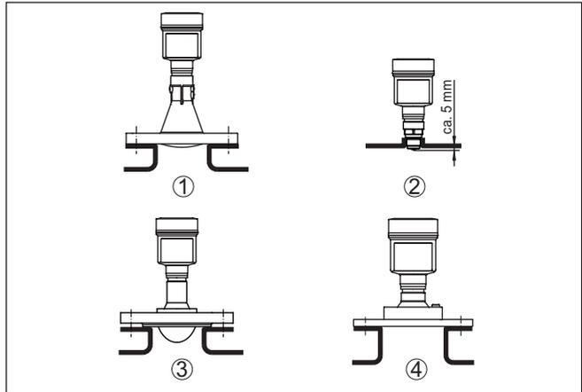
Abb. 22: Empfehlenswerte Rohrstützenmontage bei unterschiedlichen Ausführungen des VEGAPULS 6X
