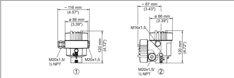
Abb. 78: Gehäuseausführungen in Schutzart IP66/IP68 (0,2 bar), (mit eingebautem Anzeige- und Bedienmodul vergrößert sich die Gehäusehöhe um 18 mm/0.71 in)
