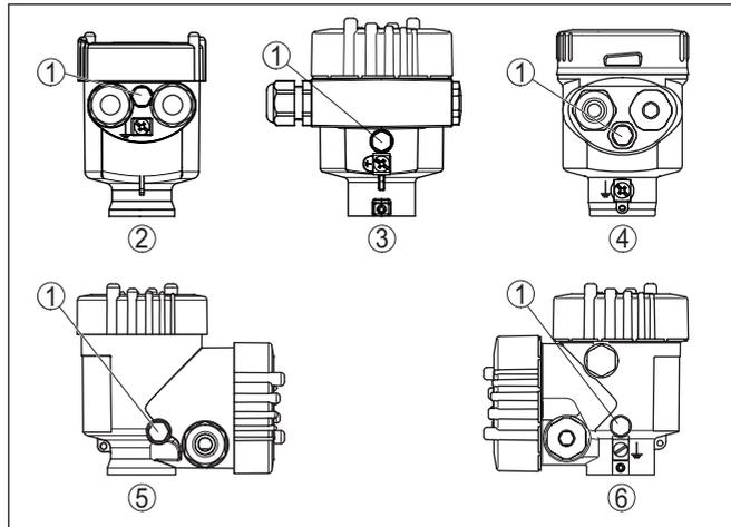
Abb. 3: Position des Filterelementes je nach Gehäuse
