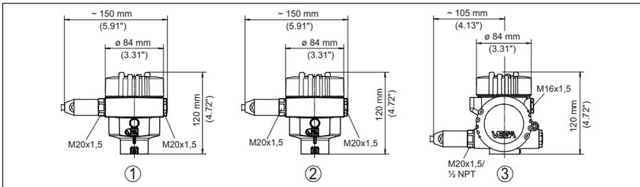
Abb. 81: Gehäuseausführungen in Schutzart IP66/IP68 (1 bar), (mit eingebautem Anzeige- und Bedienmodul vergrößert sich die Gehäusehöhe um 18 mm/0.71 in)
