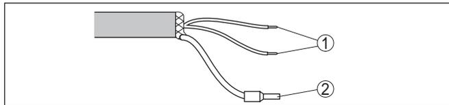
Abb. 48: Aderbelegung fest angeschlossenes Anschlusskabel
