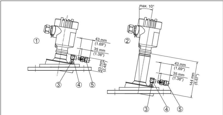
Abb. 96: VEGAPULS 6X, Flansch mit Linsenantenne, Schwenkhalterung und Spülluftanschluss
