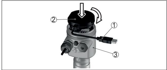
Abb. 59: Anschluss des PCs via Schnittstellenadapter direkt am Sensor
