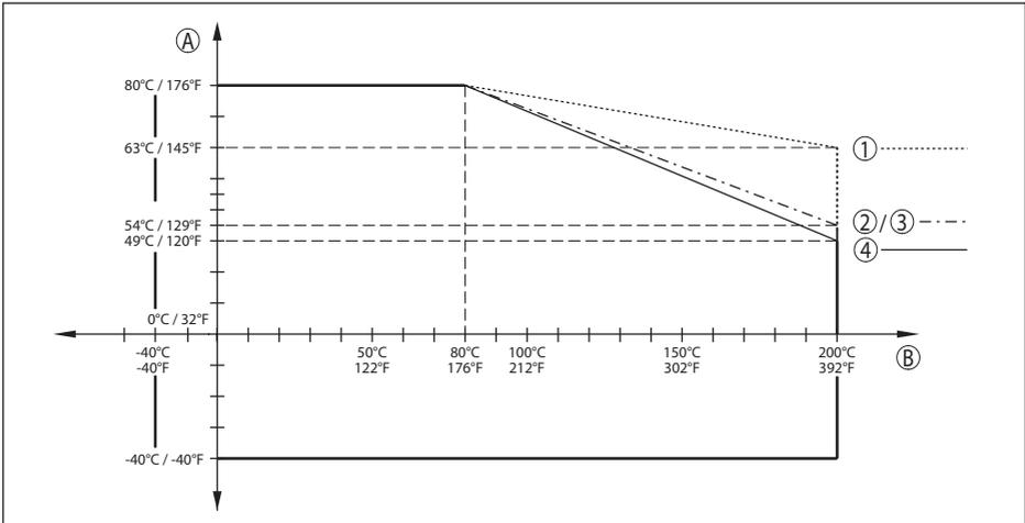
Abb. 75: Derating Umgebungstemperatur, Flansch mit Linsenantenne bis +200 °C (+392 °F)
