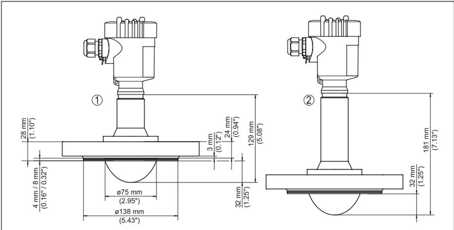
Abb. 91: VEGAPULS 6X, gekapseltes Antennensystem DN 80 PN 40
