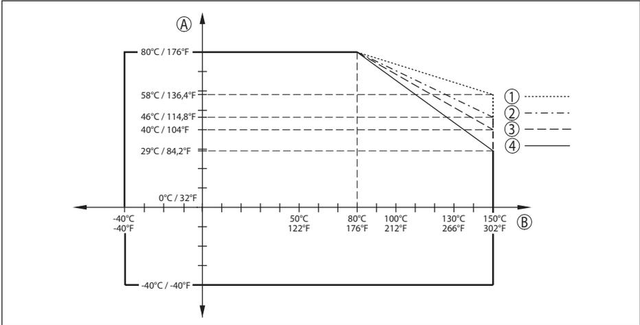
Abb. 68: Derating Umgebungstemperatur, Gewinde mit integriertem Antennensystem bis +150 °C (+302 °F)
