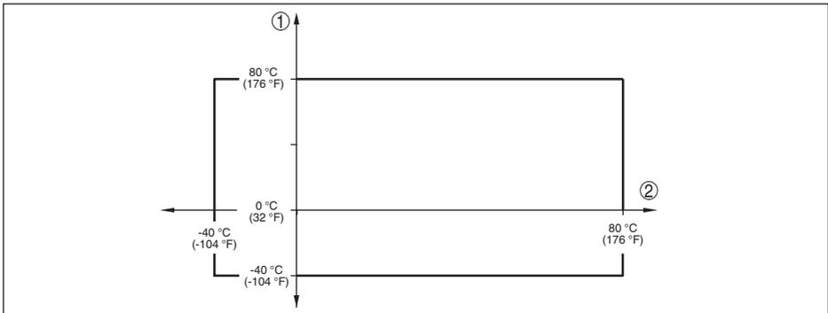
Abb. 67: Derating Umgebungstemperatur, Kunststoff-Hornantenne
