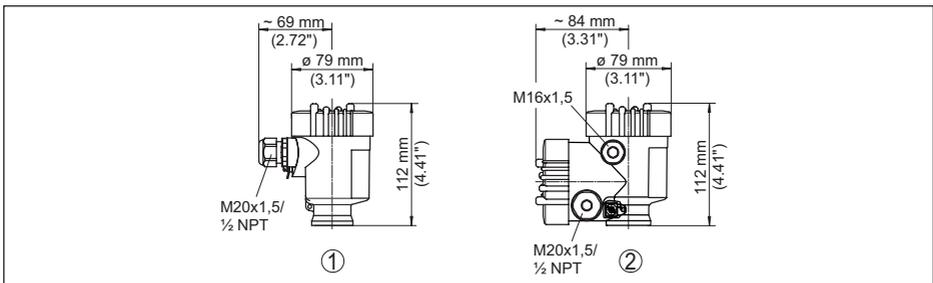
Abb. 77: Gehäuseausführungen in Schutzart IP66/IP67 (mit eingebautem Anzeige- und Bedienmodul vergrößert sich die Gehäusehöhe um 9 mm/0.35 in)
