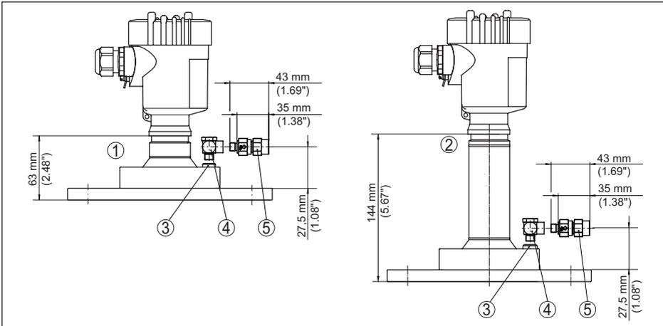
Abb. 94: VEGAPULS 6X, Flansch mit Linsenantenne und Spülluftanschluss
