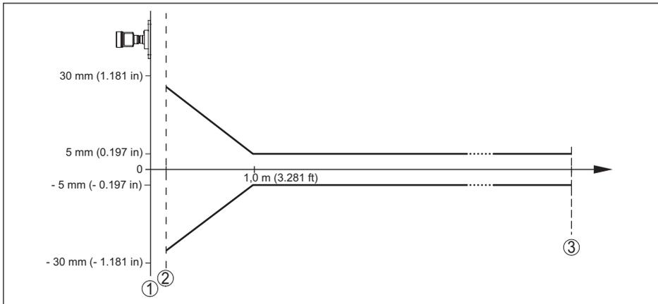
Abb. 66: Messabweichung unter Referenzbedingungen (Flansch mit Linsenantenne)
