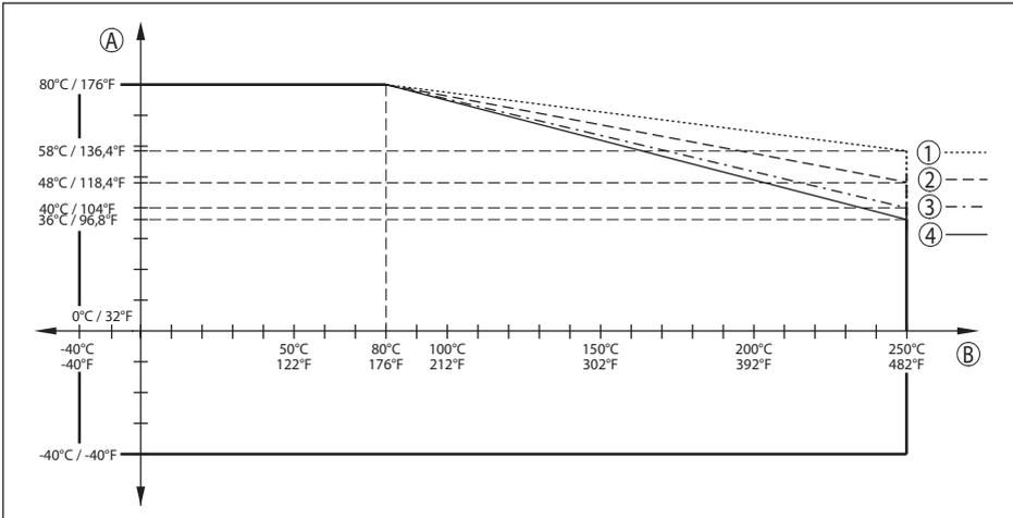
Abb. 70: Derating Umgebungstemperatur, Gewinde mit integriertem Antennensystem bis +250 °C (+482 °F)
