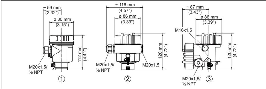
Abb. 80: Gehäuseausführungen in Schutzart IP66/IP68 (0,2 bar), (mit eingebautem Anzeige- und Bedienmodul vergrößert sich die Gehäusehöhe um 18 mm/0.71 in)
