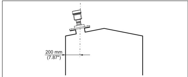
Abb. 17: Montage des Radarsensors an der Behälterdecke
