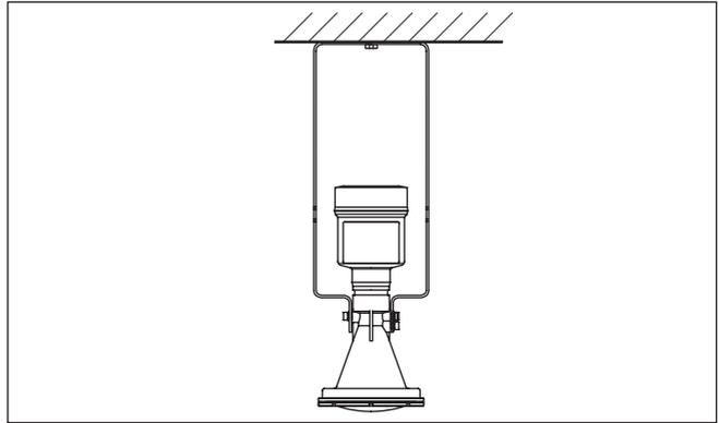
Abb. 9: Deckenmontage über den Montagebügel mit Länge 300 mm
