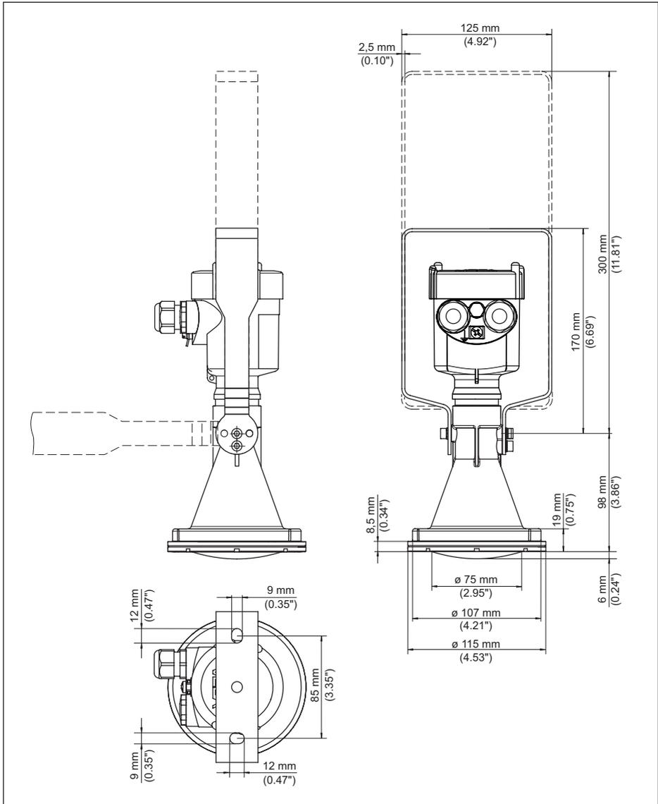
Abb. 86: VEGAPULS 6X, Kunststoff-Hornantenne, Montagebügel in 170 oder 300 mm Länge
