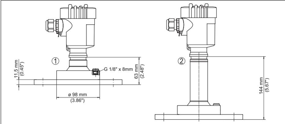
Abb. 93: VEGAPULS 6X, Flansch mit Linsenantenne (Flanschstärke siehe Zeichnung, Flanschmaße nach DIN, ASME, JIS)
