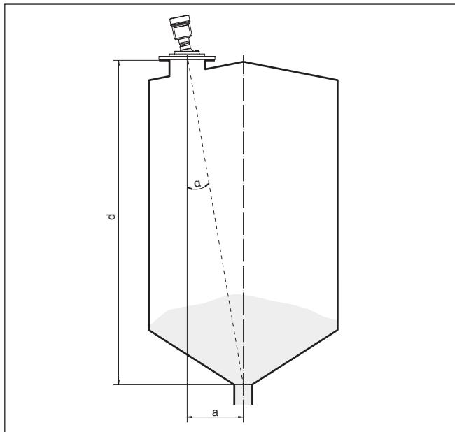
插图. 34: 测定倾斜角度以瞄准 VEGAPULS 6X
