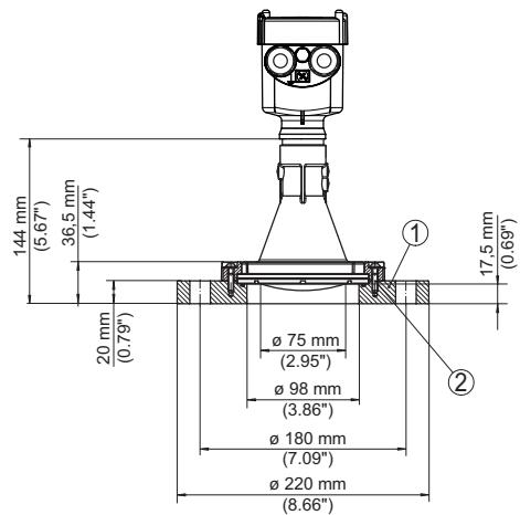
插图. 93: VEGAPULS 6X, 带适配法兰 DN 100 PN 6
