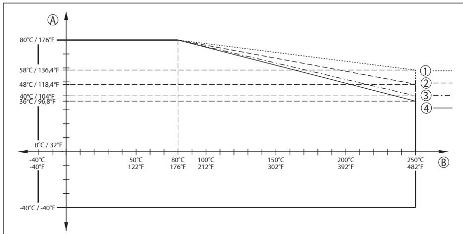
插图. 74: 环境温度降额, 带内置天线系统的螺纹, 至 +250 °C (+482 °F)
