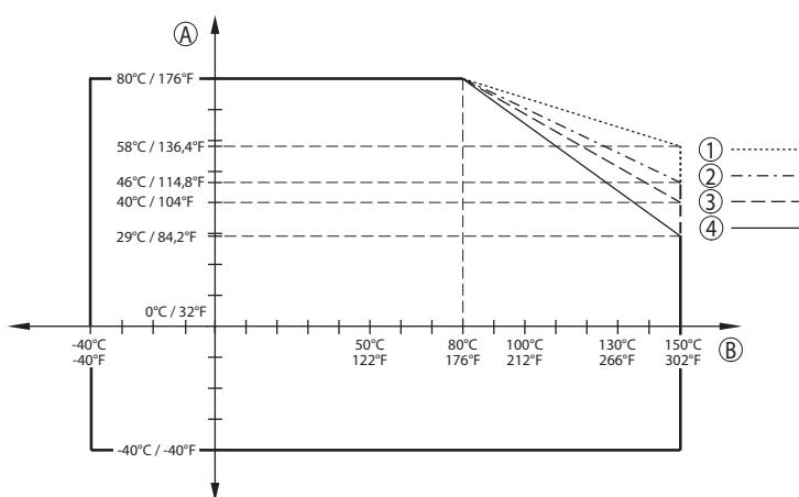
插图 83: 环境温度降额, 带喇叭口天线的法兰, 至 +150 °C (+302 °F)
