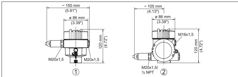
插图. 88: 采用保护等级达 IP66/IP68 (1 bar) 的壳体版本 (内装显示和调整模块后, 壳体高度增加了18 mm/0.71 in)
