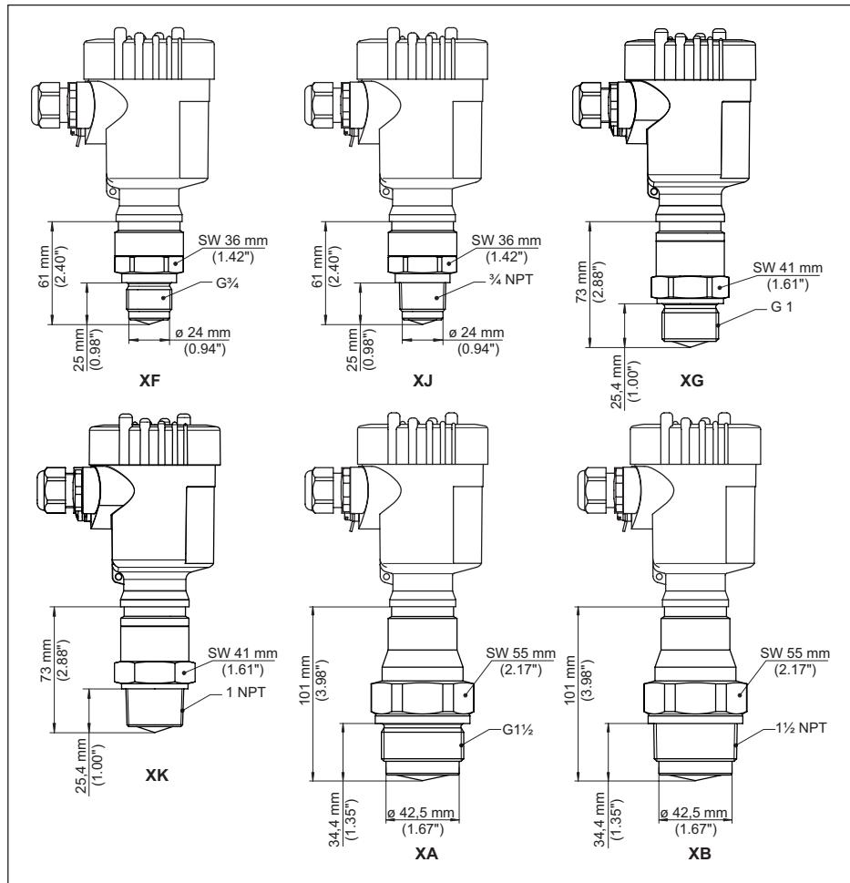
插图. 97: VEGAPULS 6X, 带有内置天线系统的螺纹, 至 +150 °C (+302 °F)
