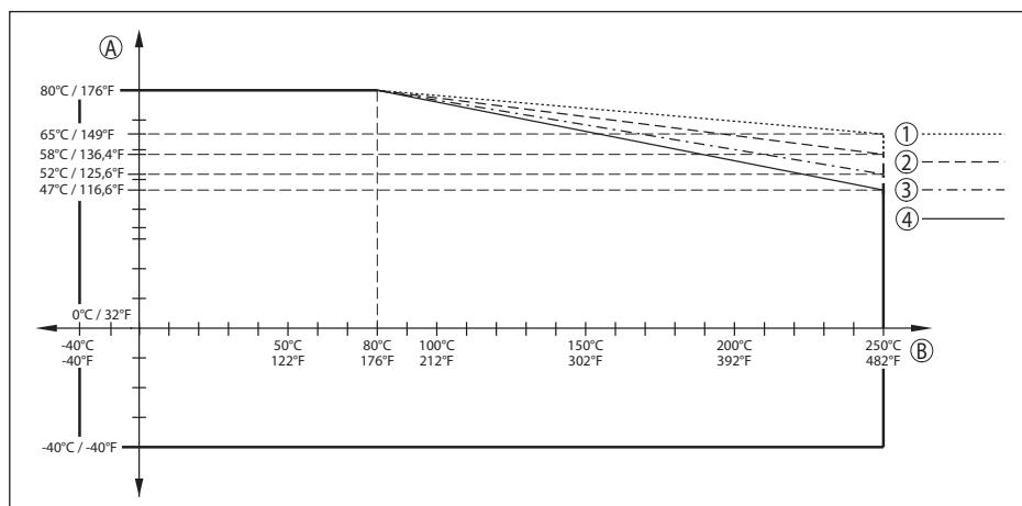
插图. 81: 环境温度降额，带透镜天线的法兰，至 +250 °C (+482 °F)
