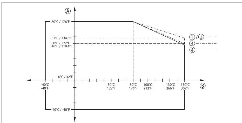
插图. 75: 环境温度降额, 带塑封天线系统的法兰, 至 +150 °C (+302 °F)
