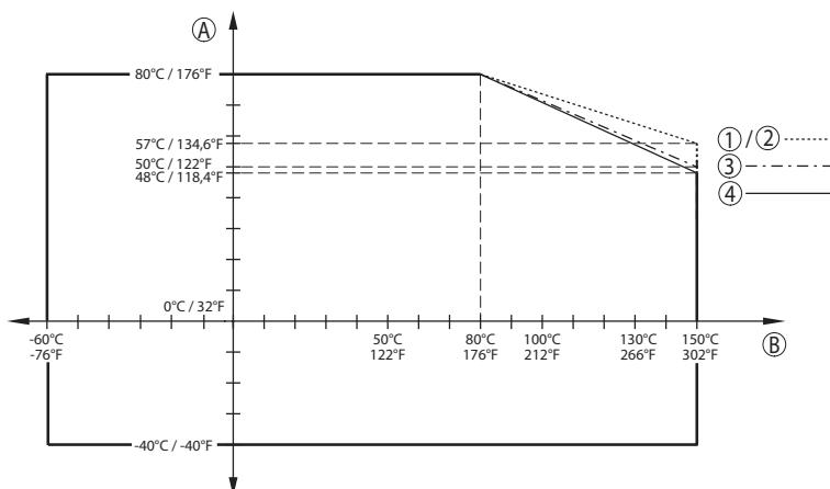
插图. 76: 环境温度降额，带塑封天线系统的法兰  $-60 \dots +150^{\circ}\text{C}$  ( $-76 \dots +302^{\circ}\text{F}$ )
