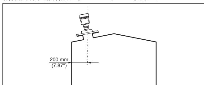
插图. 20: 将雷达传感器安装在容器盖上
