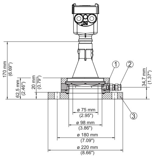
插图. 94: VEGAPULS 6X, 适配法兰和吹气接口 DN 100 PN 6
