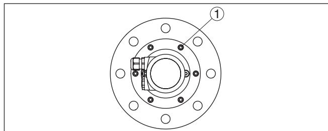
插图. 35: VEGAPULS 6X 带旋转支架
