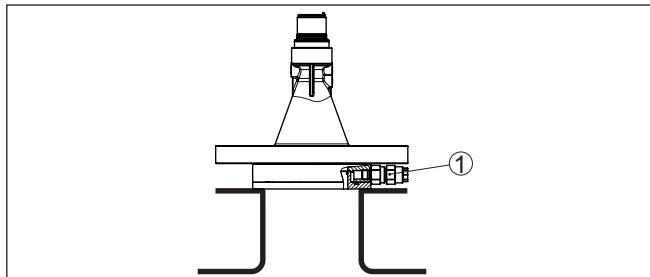
插图. 40: 塑料号角天线，带锁紧法兰
