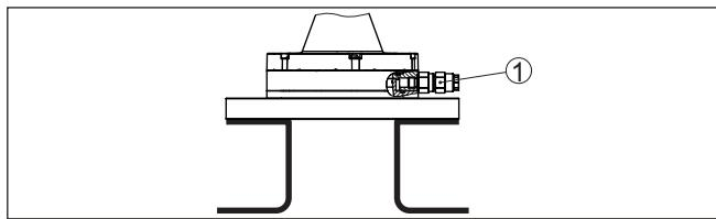
插图. 41: 带适配法兰的塑料号角天线
