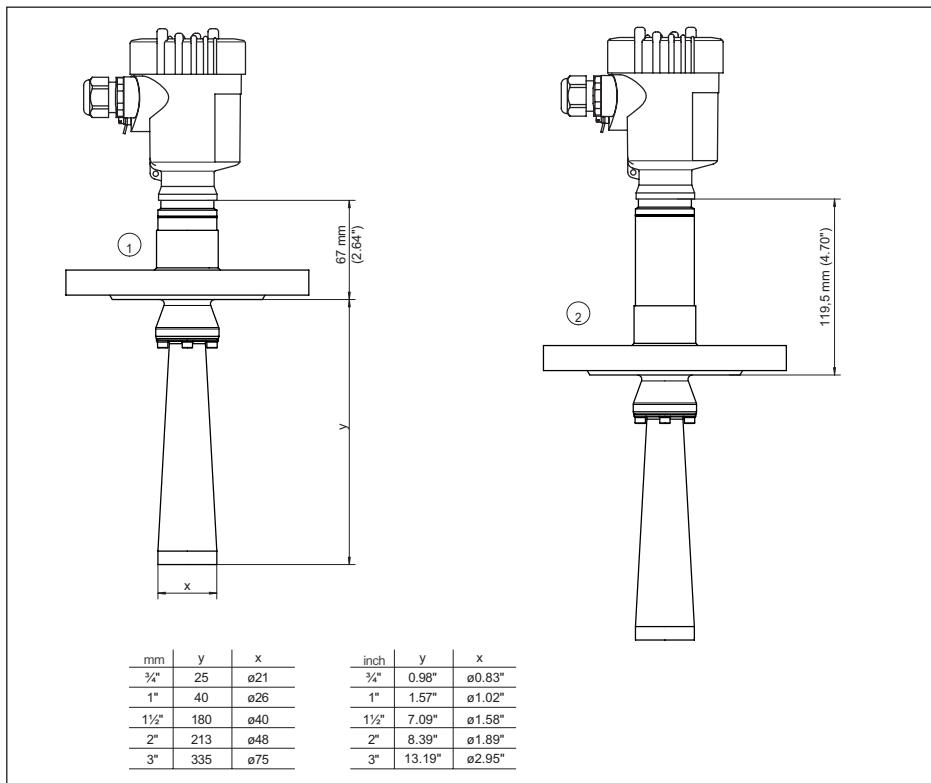
插图. 99: VEGAPULS 6X, 带有号角天线的法兰, 至 +150 °C (+302 °F)/+250 °C (+482 °F)
