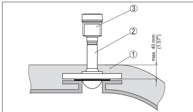
插图. 30: 将仪表安装在绝缘容器上
