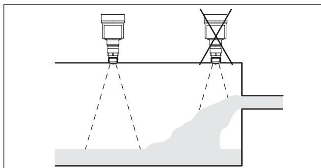
插图. 22: 流入介质时安装雷达传感器
