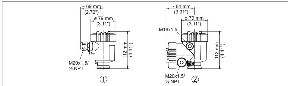
插图. 86: 采用防护等级为 IP66/IP67 的外壳版本 (内装显示和调整模块后, 外壳高度增加了 9 mm/0.35 in)
