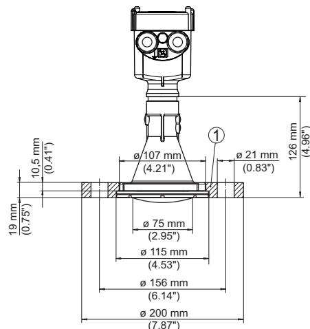
插图. 91: VEGAPULS 6X 带有锁紧法兰, 适用于法兰 3" 150 lbs, DN 80 PN 16
