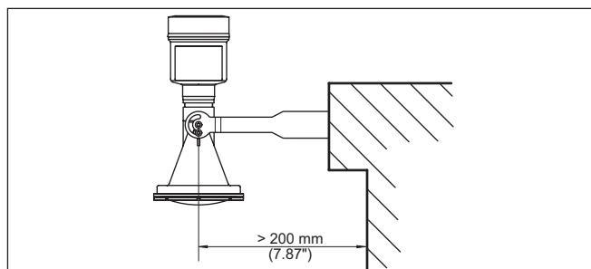
插图. 13: 用长度为 170 毫米的龙门框将仪表水平安装在墙壁上
