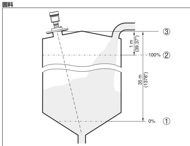
插图. 56: 参数调整举例：最小/最大调整 - 固料
