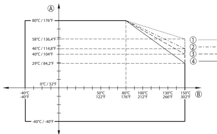
插图. 72: 环境温度降额, 带内置天线系统的螺纹, 至 +150 °C (+302 °F)
