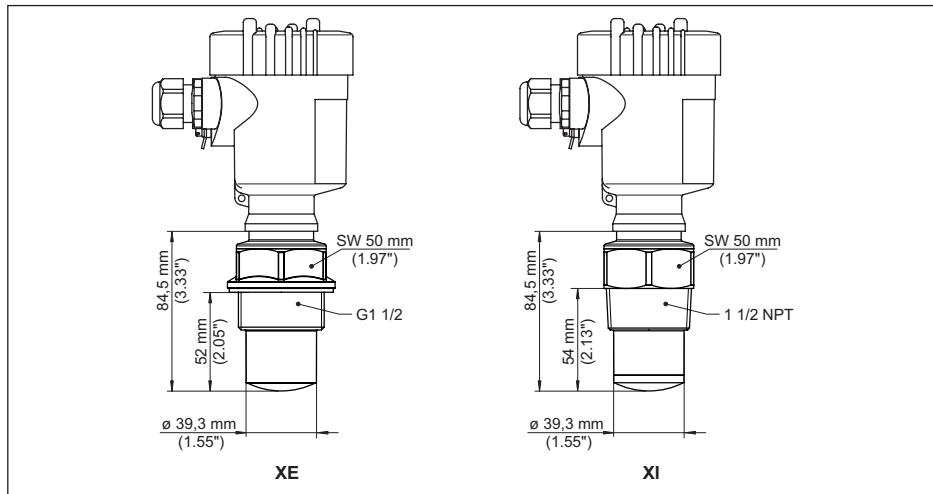
插图. 96: VEGAPULS 6X, 带有内置天线系统的螺纹, 至 +80 °C (+176 °F)
