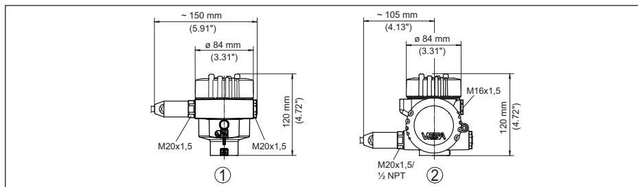
插图. 90: 采用防护等级达 IP66/IP68 (1 bar) 的壳体版本 (内装显示和调整模块后, 壳体高度增加了18 mm/0.71 in)
