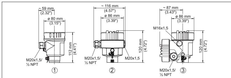
插图. 89: 采用防护等级达 IP66/IP68 (0.2 bar) 的壳体版本, (内装显示和调整模块后, 壳体高度增加了18 mm/0.71 in)
