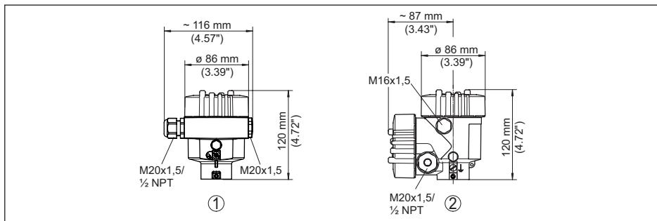
插图. 87: 采用防护等级达 IP66/IP68 (0.2 bar) 的壳体版本, (内装显示和调整模块后, 壳体高度增加了18 mm/0.71 in)
