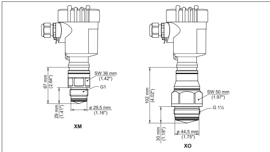
插图. 104: VEGAPULS 6X , 用于卫生型适配器的螺纹
