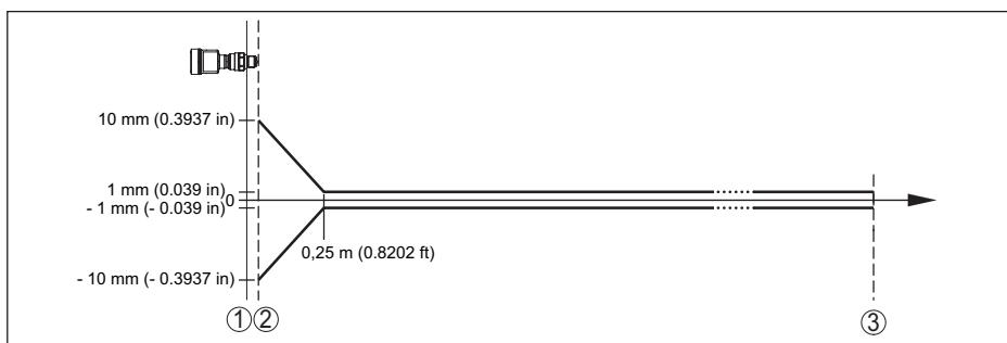
插图. 70: 基准条件下的测量误差 (以带有内置天线系统的螺纹为例，相应地适用于所有版本)<sup>27)</sup>
