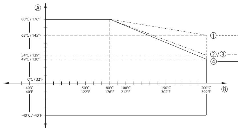
插图. 80: 环境温度降额，带透镜天线的法兰，至 +200 °C (+392 °F)
