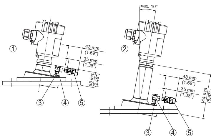
插图. 110: VEGAPULS 6X, 带有透镜天线、万向节和吹气接口的法兰
