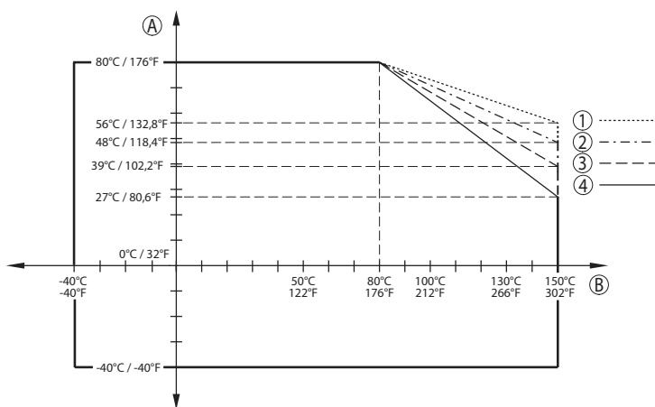
插图 82: Derating Umgebungstemperatur, Hygieneanschluss bis +150 °C (+302 °F)
