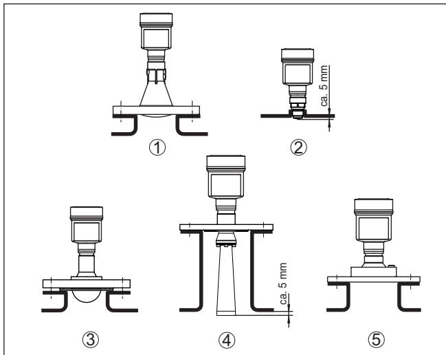
插图. 25: 对于不同版本的 VEGAPULS 6X 的安装管接头的推荐参数
