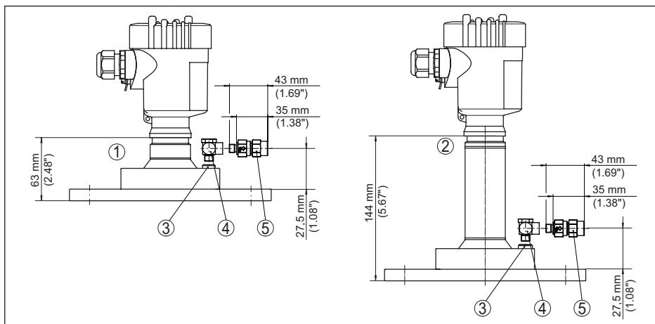
插图. 108: VEGAPULS 6X, 带有透镜天线和吹气接口的法兰
