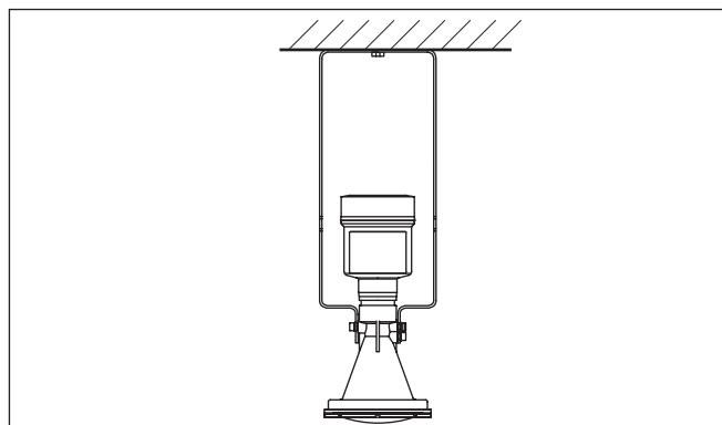
插图. 12: 用长度为 300 毫米的龙门框将仪表安装到天花板上
