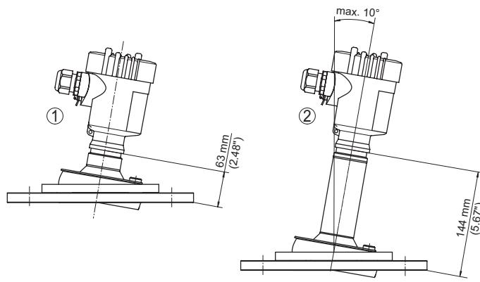
插图. 109: VEGAPULS 6X, 带有透镜天线和万向节的法兰
