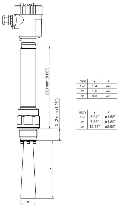
插图. 100: VEGAPULS 6X, 带有号角天线的螺纹 , 450 °C 型
