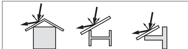
插图. 31: 用散射挡板来覆盖光滑的型材
