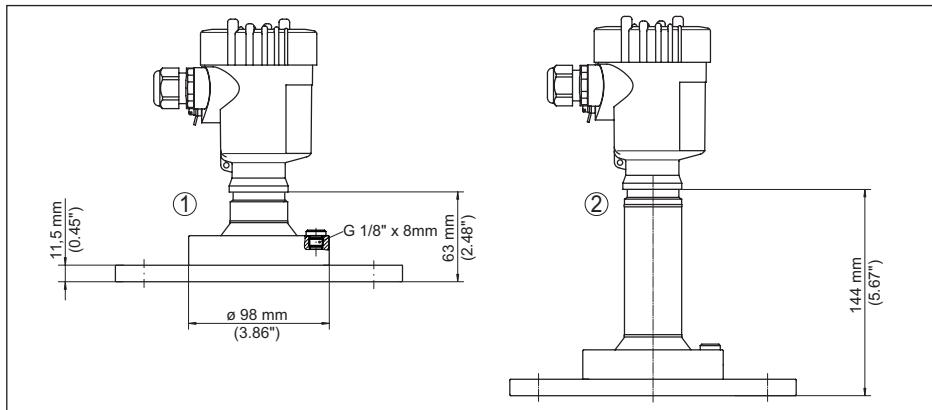
插图. 107: VEGAPULS 6X, 带有透镜天线的法兰 (法兰厚度参见图纸, 法兰尺寸根据 DIN, ASME, JIS)
