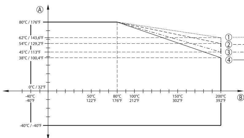
插图. 77: 环境温度降额，带塑封天线系统的法兰，至  $+200^{\circ}\text{C}$  ( $+392^{\circ}\text{F}$ )
