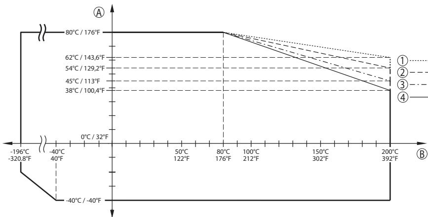
插图. 78: 环境温度降额，带塑封天线系统的法兰 -196 ... +200 °C (-320.8 ... +392 °F)
