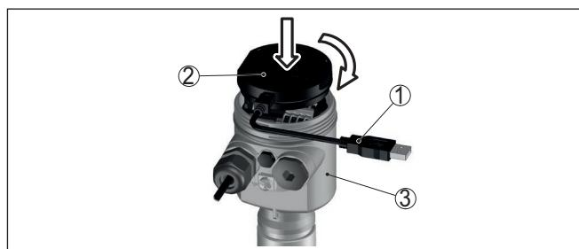
插图. 62: 通过接口适配器将电脑直接与传感器相连
