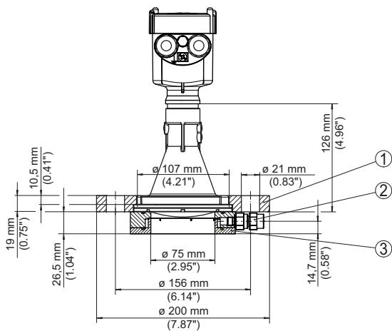
插图. 92: VEGAPULS 6X, 带有锁紧法兰和吹气接口, 适用于 3" 150 lbs, DN 80 PN 16
