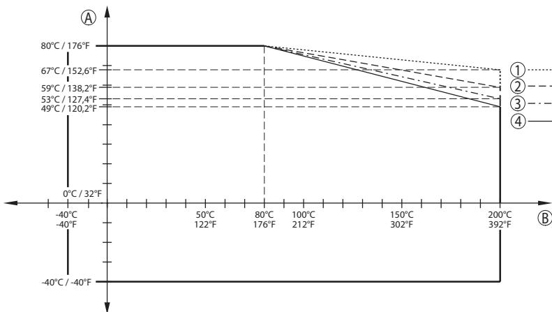
插图. 84: 环境温度降额, 带喇叭口天线的法兰, 至 +200 °C (+392 °F)
