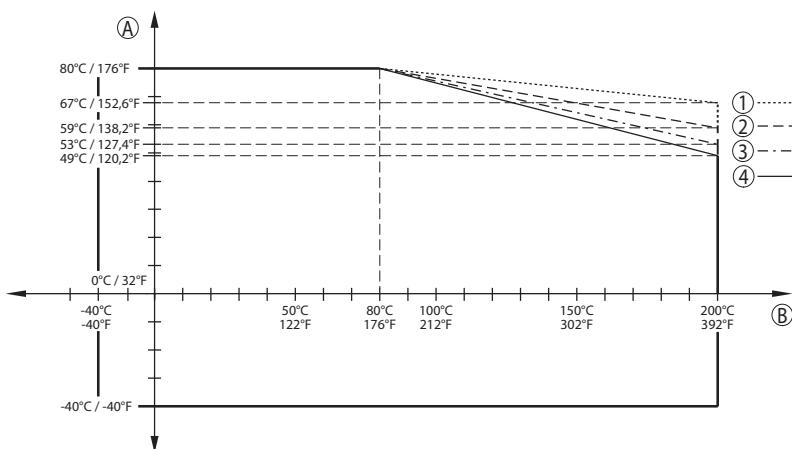
插图. 73: 环境温度降额, 带内置天线系统的螺纹, 至 +200 °C (+392 °F)
