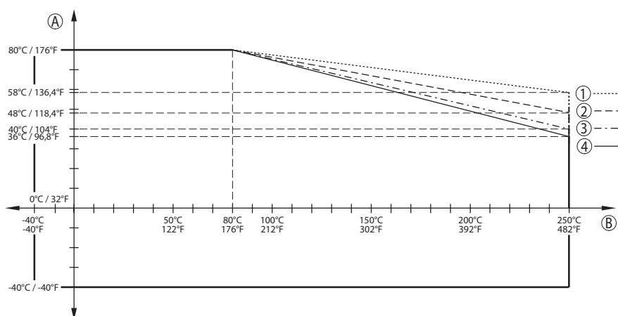
插图. 85: 环境温度降额, 带喇叭口天线的法兰, 至 +250 °C (+482 °F)
