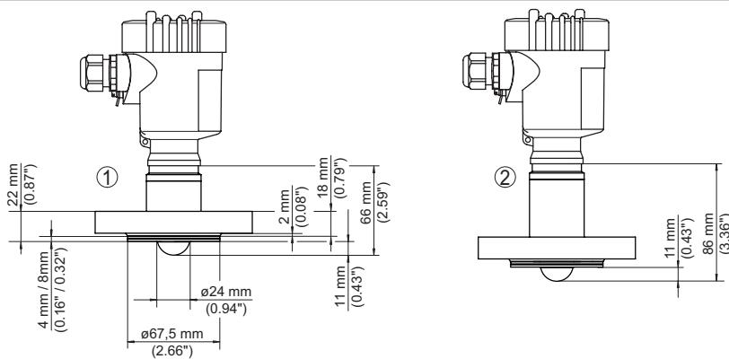
插图. 102: VEGAPULS 6X, 封装天线系统 DN 25 PN 40
