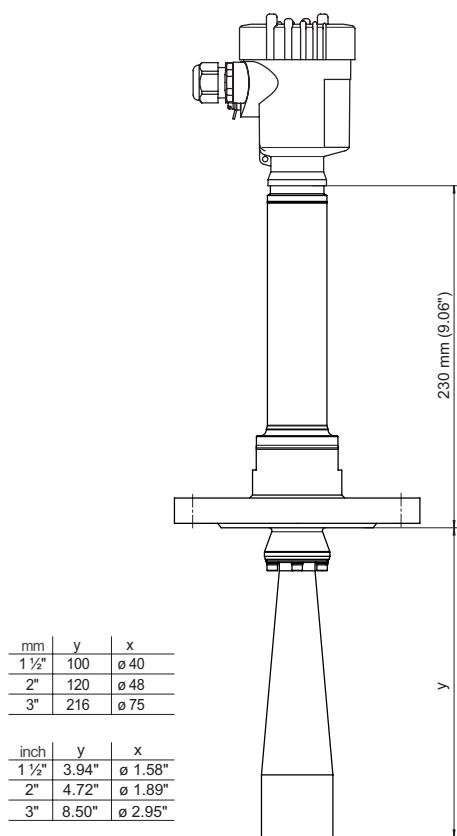
插图. 101: VEGAPULS 6X, 带有号角天线的法兰 , 450 °C 型
