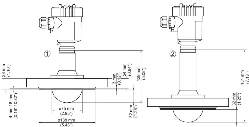
插图. 103: VEGAPULS 6X, 封装天线系统 DN 80 PN 40
