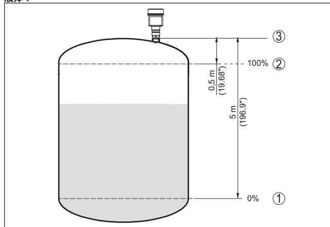
插图. 55: 参数调整举例：最小/最大调整 - 液体
