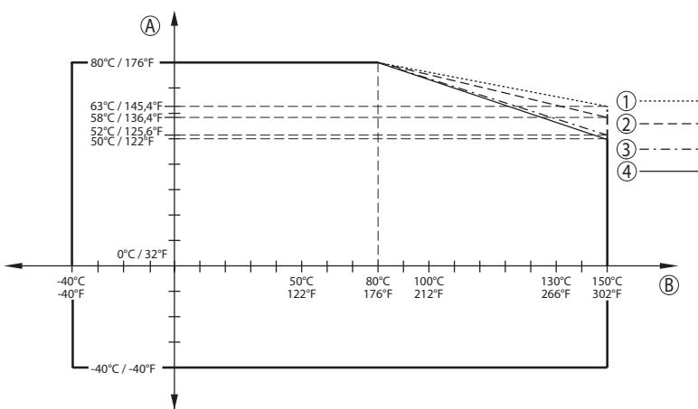
插图. 79: 环境温度降额，带透镜天线的法兰，至 +150 °C (+302 °F)
