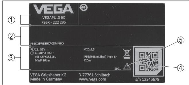
Fig. 1: Présentation de la plaque signalétique (exemple)
