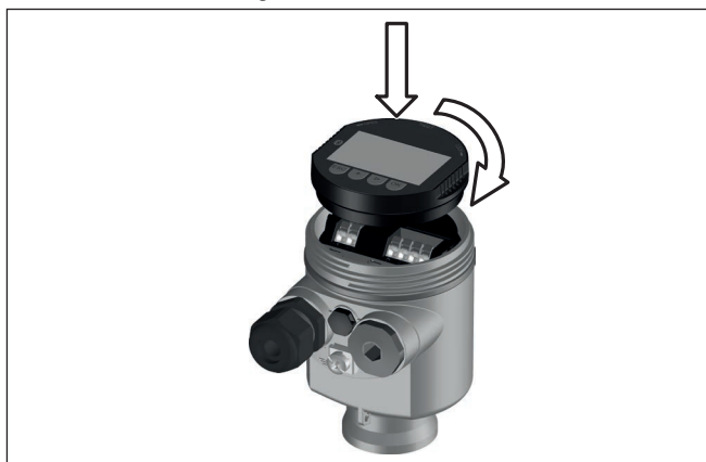
Figura 50: Inserimento del tastierino di taratura con display nel vano dell'elettronica in caso di custodia ad una camera
