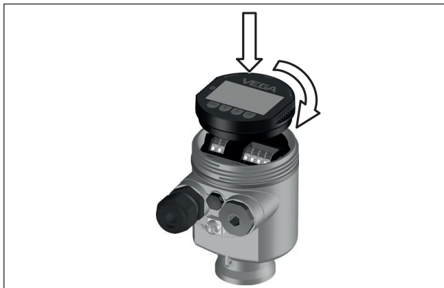
Fig. 51: Plaatsen van de display- en bedieningsmodule bij eenkamerbehuizing in elektronicaruimte.
