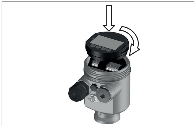
Fig. 50: Plaatsen van de display- en bedieningsmodule bij eenkamerbehuizing in elektronicaruimte.
