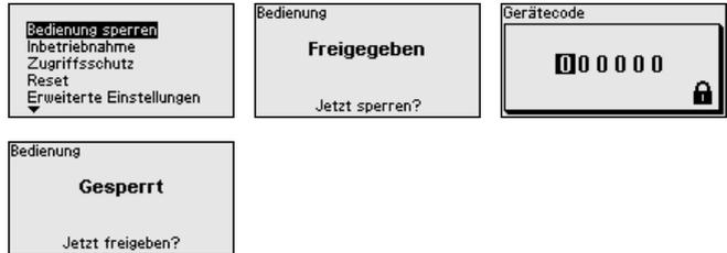
Bei gesperrter Bedienung sind nur noch folgende Bedienfunktionen ohne Eingabe des Gerätecodes möglich:
