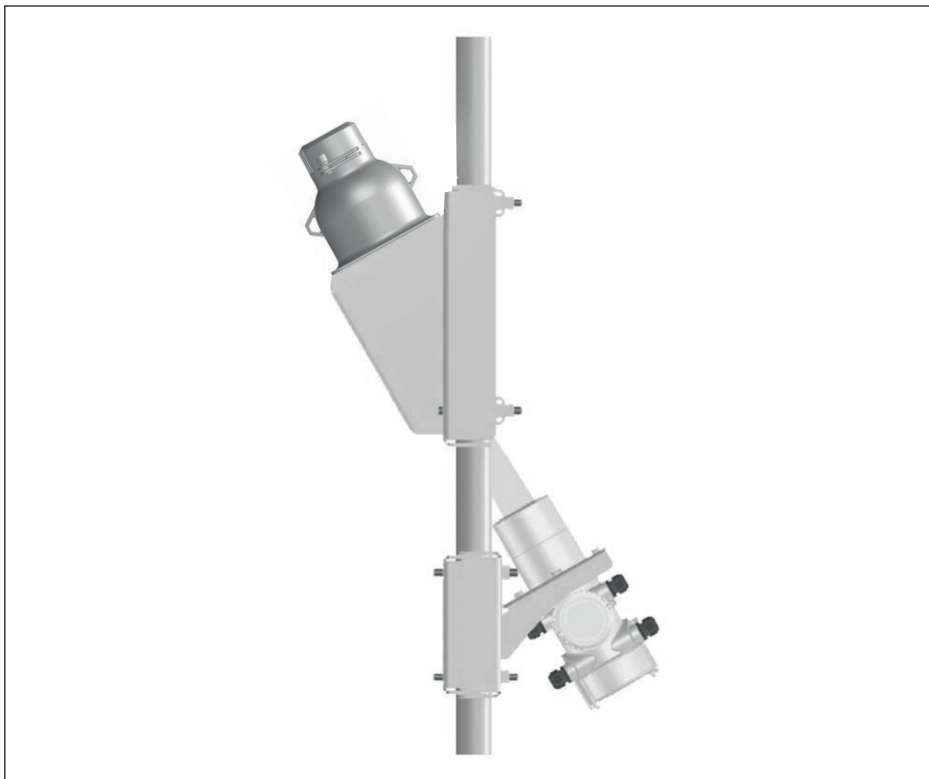
Abb. 45: Klemmvorrichtung für den schrägen Anbau an Rohre von 50 ... 100 mm (1.97 ... 3.94 in)
