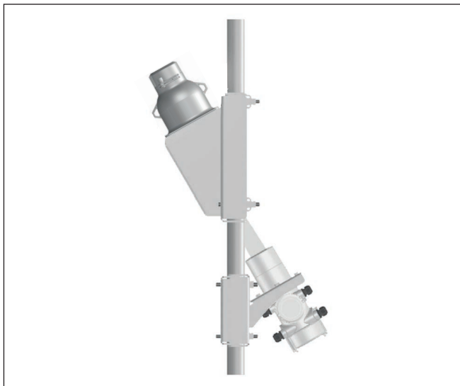
Fig. 15: Configuración de medición de 30° en una tubería con diámetro 50 ... 100 mm (1.97 ... 3.94 in)
