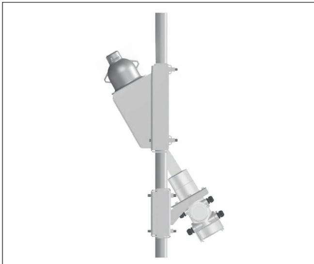
*Figura 15: Configurazione per la misura a 30° su una tubazione con diametro di 50 ... 100 mm (1.97 ... 3.94 in)*
