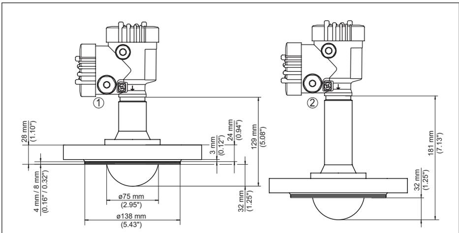
Fig. 92: VEGAPULS 6X, système d'antennes encapsulé DN 80 PN 40
