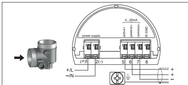
Fig. 46: Compartiment de raccordement boîtier deux chambres pour très basse tension
