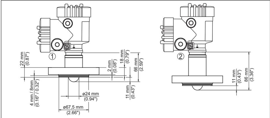
Fig. 91: VEGAPULS 6X, système d'antenne encapsulé DN 25 PN 40
