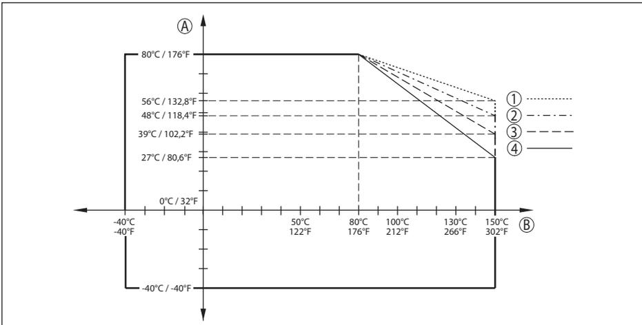
Fig. 75: Derating température ambiante, raccord hygiénique jusqu'à +150 °C (+302 °F)
