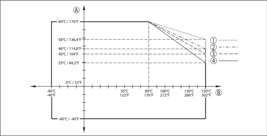
Fig. 65: Derating température ambiante, filetage avec système d'antenne intégré jusqu'à +150 °C (+302 °F)
