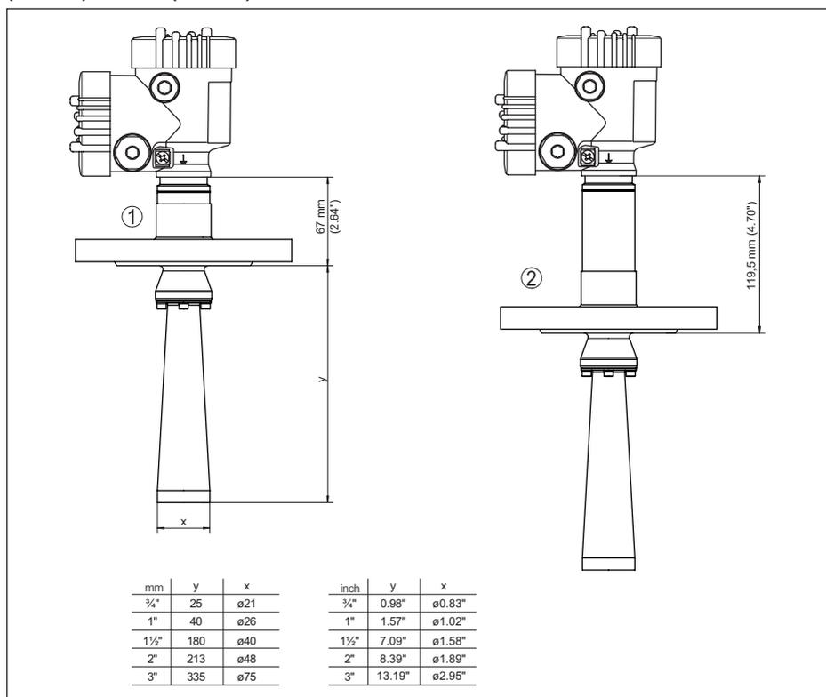
Fig. 88: VEGAPULS 6X, bride avec antenne cône jusqu'à +150 °C (+302 °F)/+250 °C (+482 °F)
