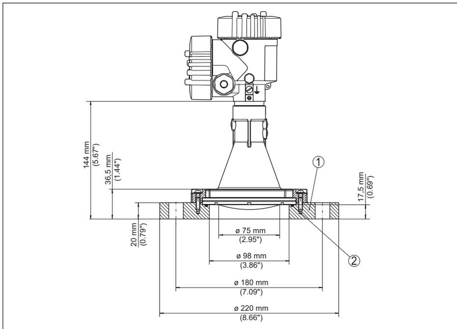
Fig. 82: VEGAPULS 6X avec bride d'adaptation DN 100 PN 6
