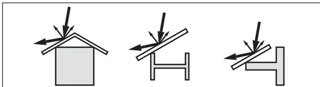
Fig. 29: Recouvrir les obstacles lisses par des déflecteurs
