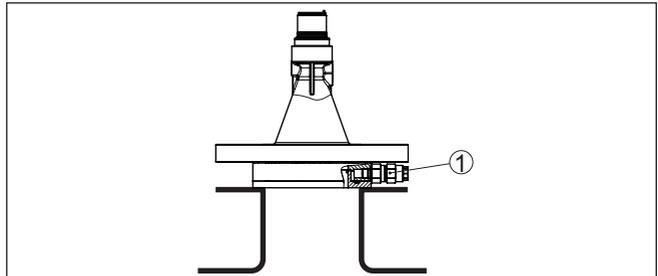
Fig. 38: Antenne cône en plastique avec bride tournante
