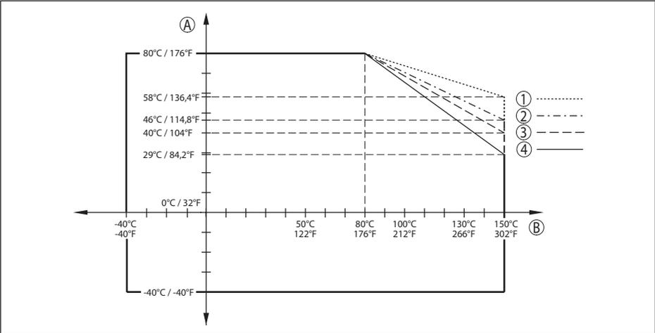
Fig. 76: Derating température ambiante, bride avec antenne cône jusqu'à +150 °C (+302 °F)
