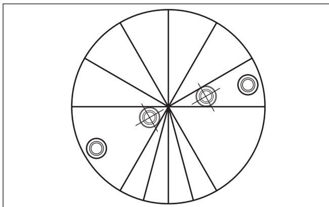
Fig. 36: Montage et orientation dans un silo compartimenté
