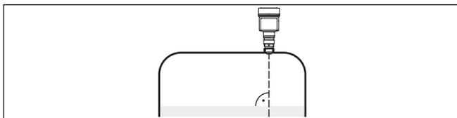
Fig. 30: Orientation du capteur dans les liquides
