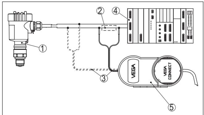
Fig. 3: Raccordement du PC à la ligne signal
