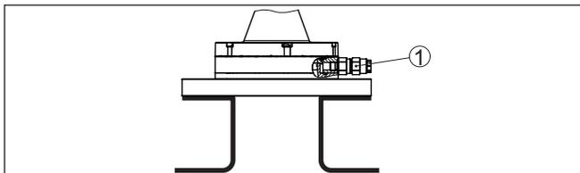
Fig. 39: Antenne cône en plastique avec bride d'adaptation
