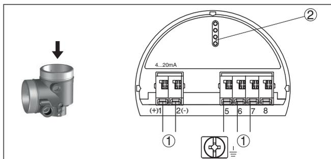
Fig. 45: Compartiment électronique - boîtier à deux chambres
