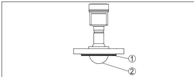
Fig. 25: VEGAPULS 6X avec bride et système d'antenne encapsulé
