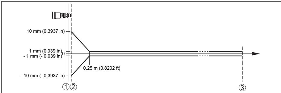
Fig. 63: Écart de mesure sous les conditions de référence (exemple filetage avec système d'antenne intégré, s'applique en conséquence pour toutes les versions)<sup>25)</sup>
