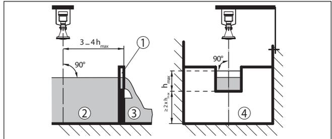
Fig. 42: Mesure du débit avec déversoir rectangulaire:  $h_{\text{max}}$  = remplissage max. du déversoir rectangulaire
