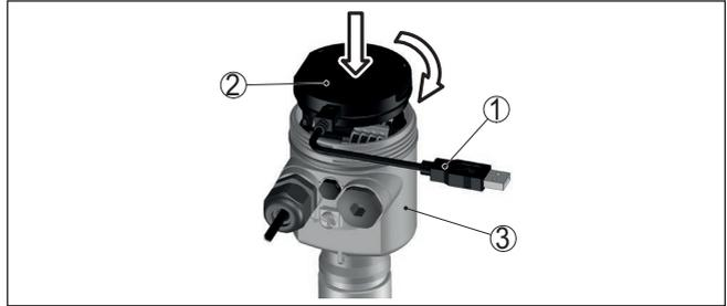
Fig. 57: Raccordement du PC directement au capteur via l'adaptateur d'inter-
