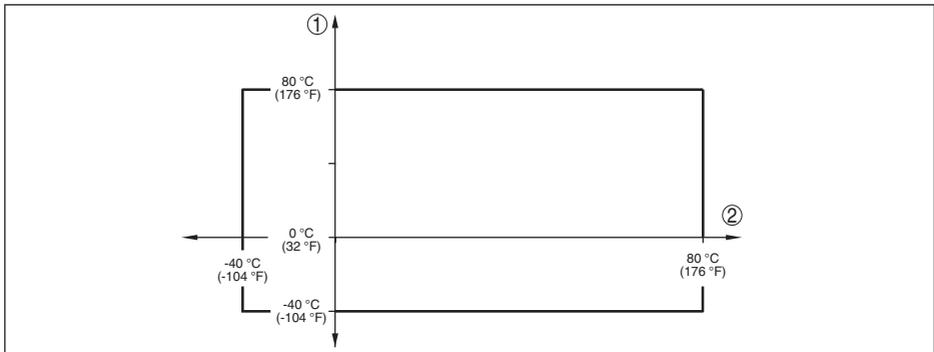
Fig. 64: Derating température ambiante, antenne cône en plastique
