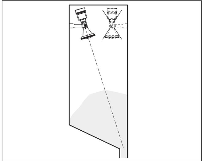
Fig. 37: Montage et orientation dans un silo compartimenté
