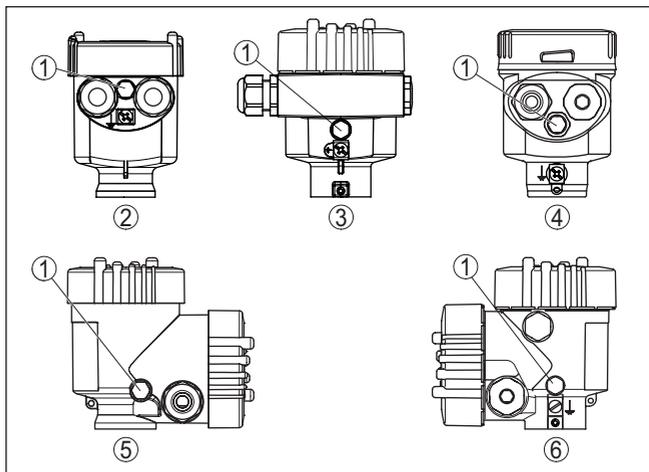
Fig. 4: Position du filtre en fonction du boîtier
