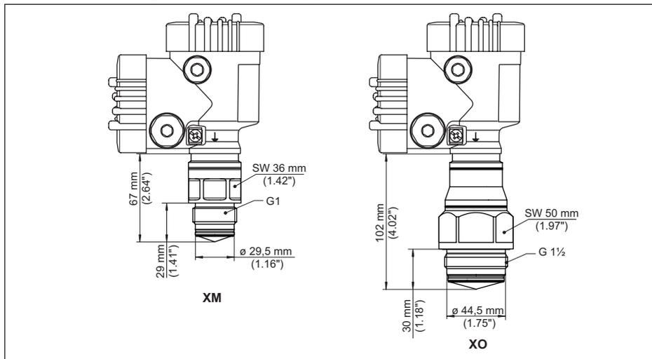
*Fig. 93: VEGAPULS 6X, filetage pour adaptateur hygiénique*
