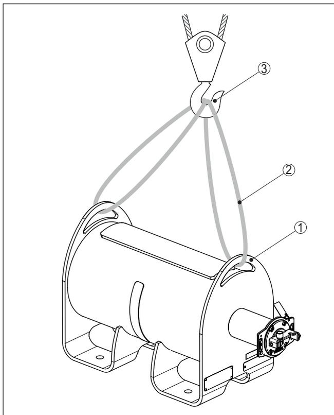
Fig. 6: Transport par grue du conteneur blindé
