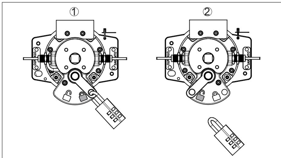
Fig. 20: Affichage de l'état de commutation sur VEGASOURCE 85 - Version B - Commutation MARCHÉ/ARRÊT pneumatique
