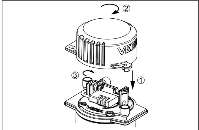
Fig. 10: Mise en place du capuchon de protection
