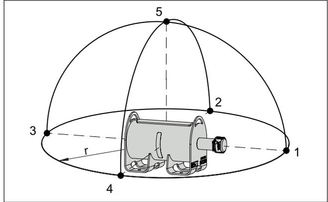
Fig. 21: Points de mesure pour la mesure de débit de dose locale
