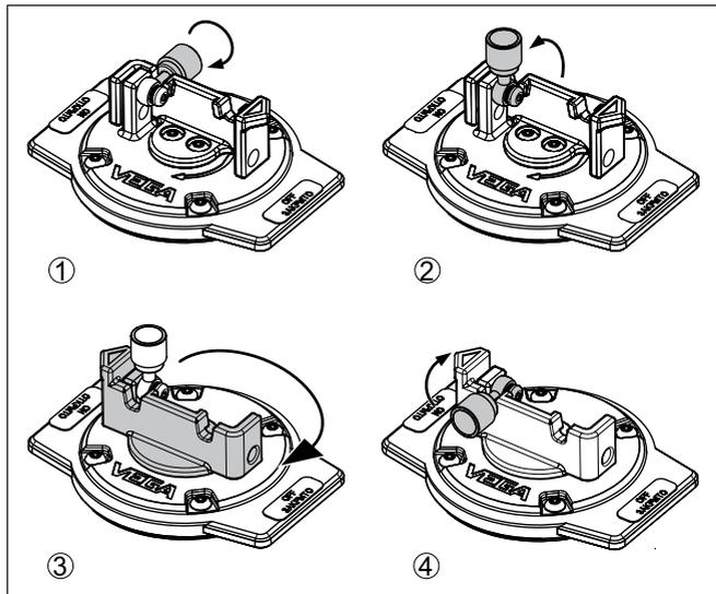
Fig. 16: Mise en marche du rayonnement - VEGASOURCE 85 Version X, C
