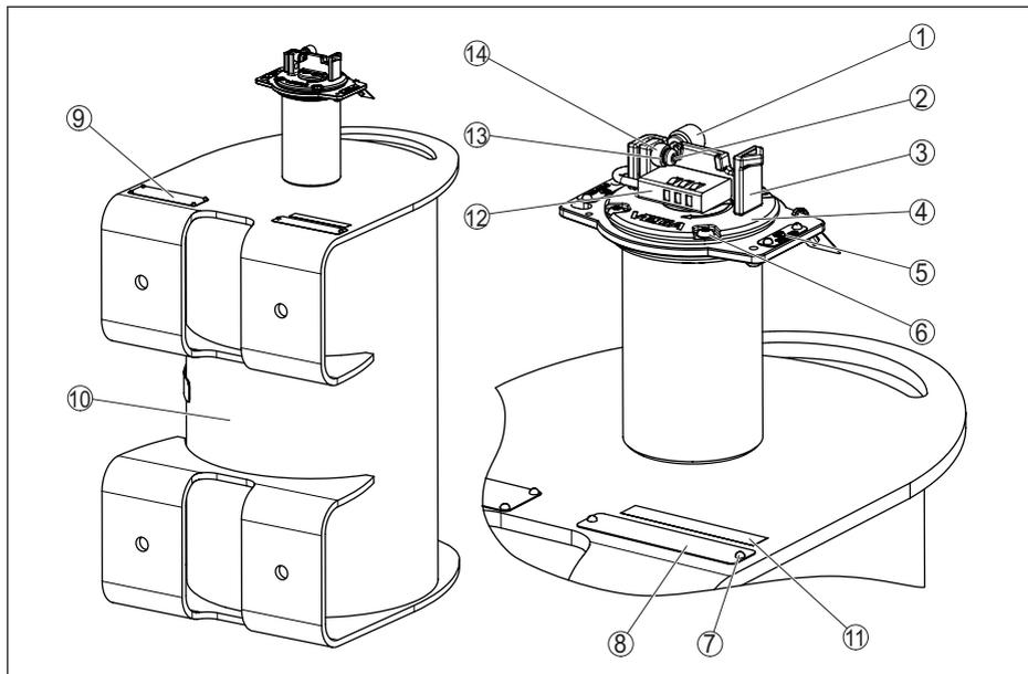
Fig. 23: Matériaux VEGASOURCE 85 - version X, C
