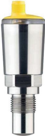
Der Sensor (1) erfasst gleichzeitig den kapazitiven und den resistiven Anteil des Messsignals. Wird die Messspitze mit Medium bedeckt, kann der Sensor damit zwischen Anhaftung und tatsächlicher Bedeckung unterscheiden. Die Art der Änderung wird von der intelligenten Messwerterfassung erkannt und in einen Schaltbefehl umgewandelt. Anhaftungen werden bis zu einem bestimmten Grad ignoriert und haben damit keinen Einfluss auf die Messung.
