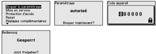
Si le réglage est verrouillé, seules les fonctions de commande suivantes sont possibles sans saisie du code d'appareil :
