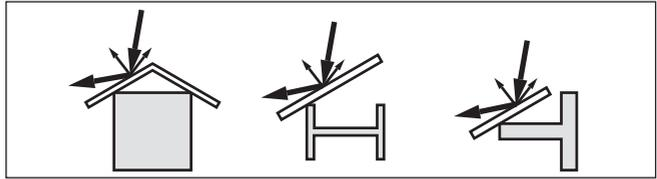
Fig. 30: Recouvrir les obstacles lisses par des déflecteurs
