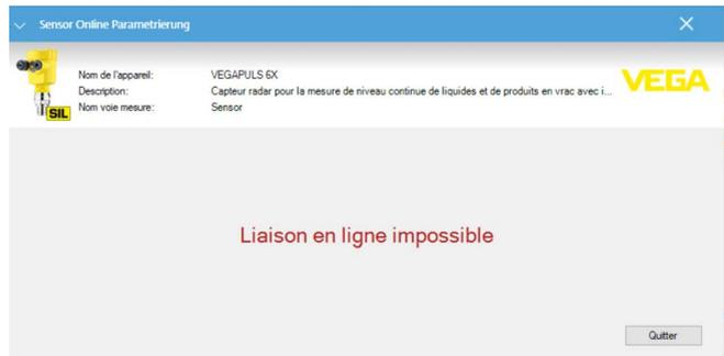
Fig. 16: Vue DTM VEGAPULS 6X mode en ligne connexion interrompue (non synchronisé)
