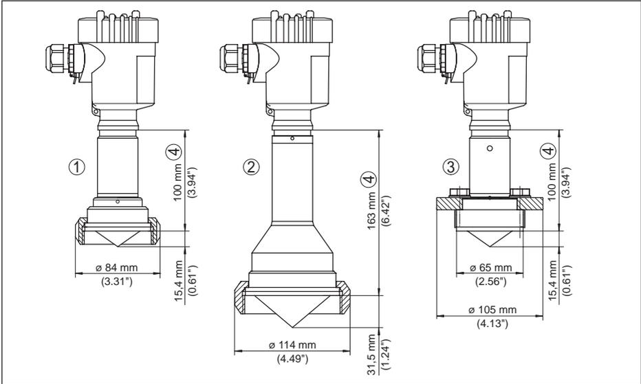
Abb. 49: VEGAPULS 63, Hygieneanschluss 4
