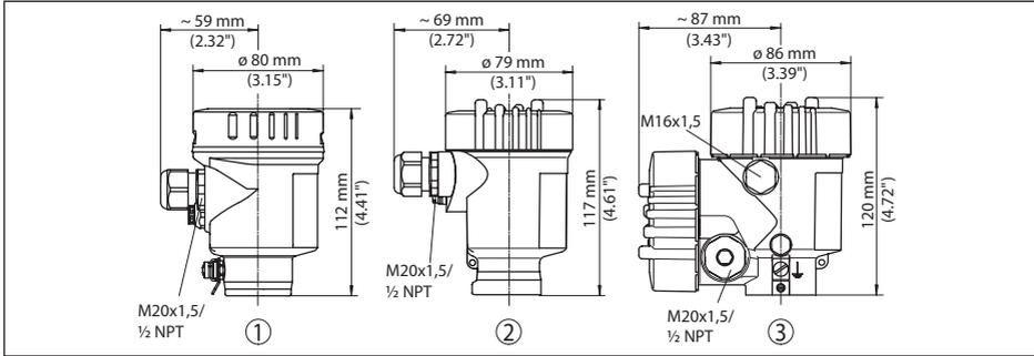
Abb. 42: Gehäuseausführungen in Schutzart IP 66/IP 68 (0,2 bar), (mit eingebautem Anzeige- und Bedienmodul vergrößert sich die Gehäusehöhe bei Position 1 um 9 mm/0.35 in, bei Position 2 und 3 um 18 mm/0.71 in)
