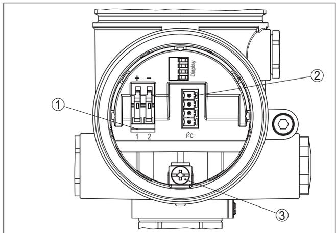
Abb. 23: Anschlussraum - Zweikammergehäuse
