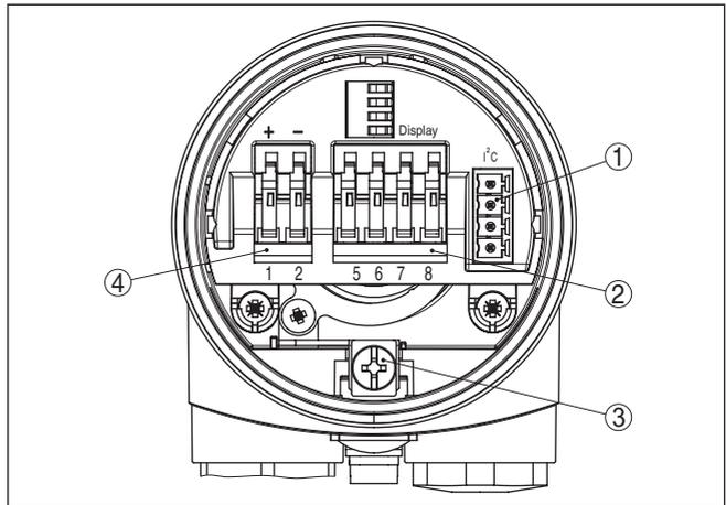
Abb. 19: Elektronik- und Anschlussraum - Einkammergehäuse
