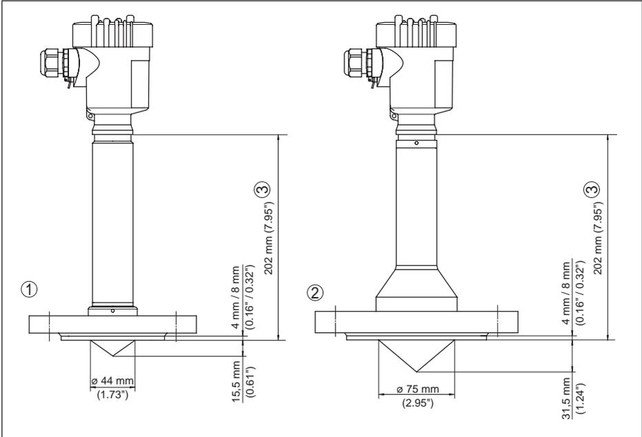
Abb. 45: VEGAPULS 63, Flanschausführung, Tieftemperatur
