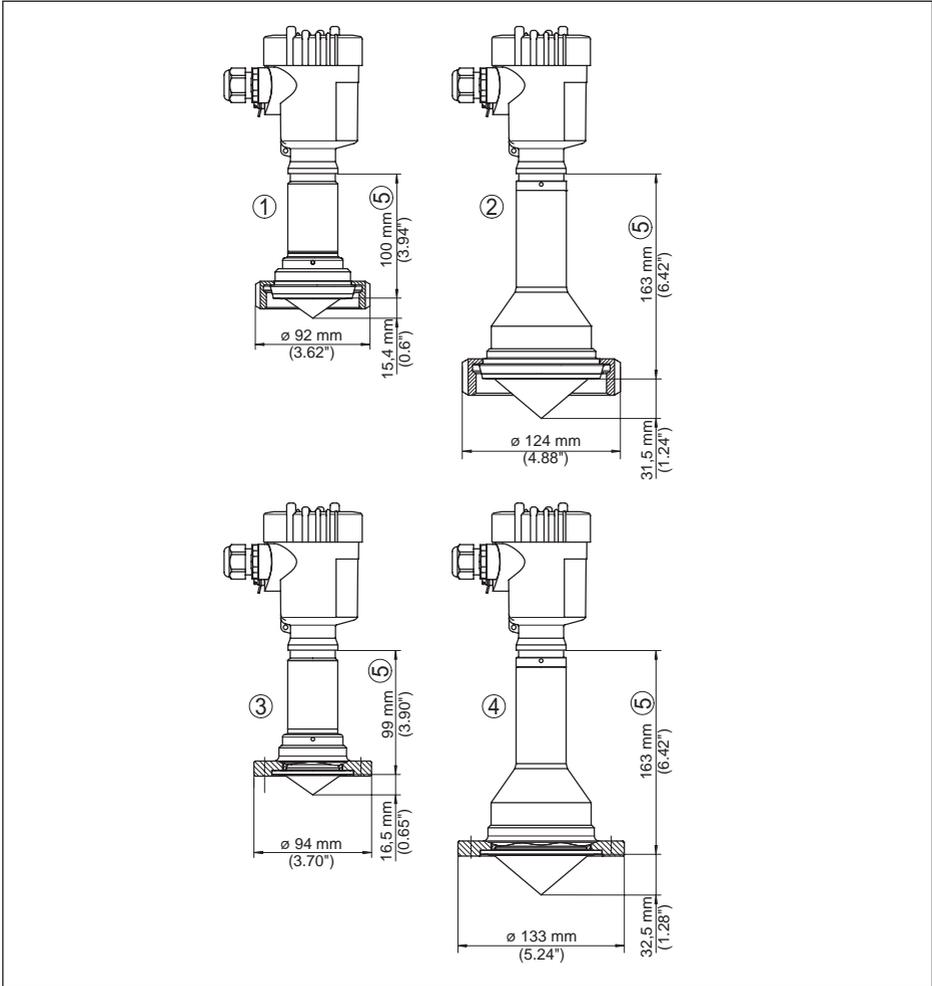
Abb. 48: VEGAPULS 63, Hygieneanschluss 3
