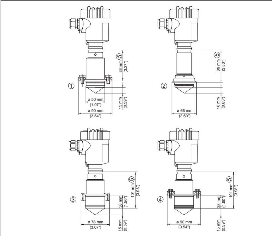
Abb. 46: VEGAPULS 63, Hygieneanschluss 1
