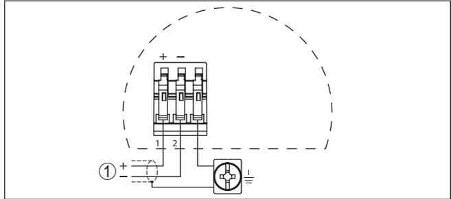
Abb. 28: Anschlussplan Ex-d-ia-Zweikammergehäuse
