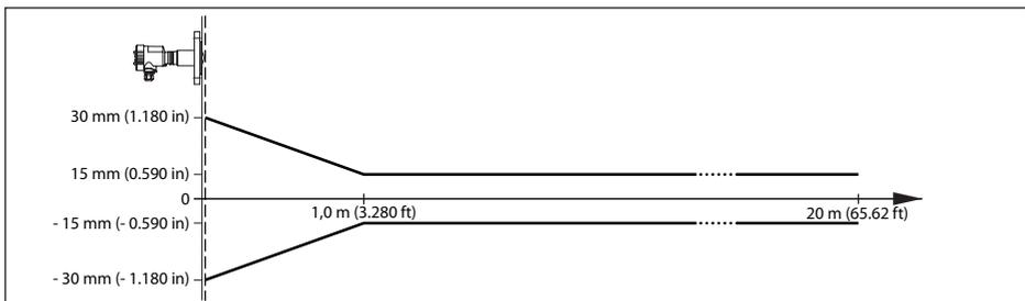
Abb. 38: Messabweichung VEGAPULS 63 mit erhöhter Empfindlichkeit in mm, Messbereich in m
