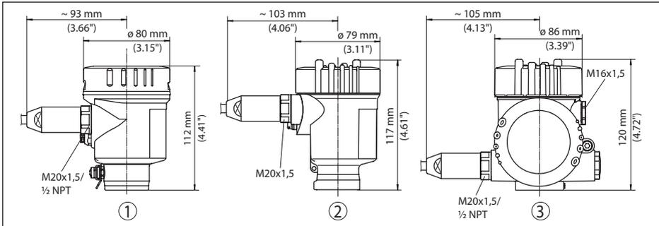
Abb. 43: Gehäuseausführungen in Schutzart IP 66/IP 68 (1 bar), (mit eingebautem Anzeige- und Bedienmodul vergrößert sich die Gehäusehöhe um 18 mm/0.71 in)
