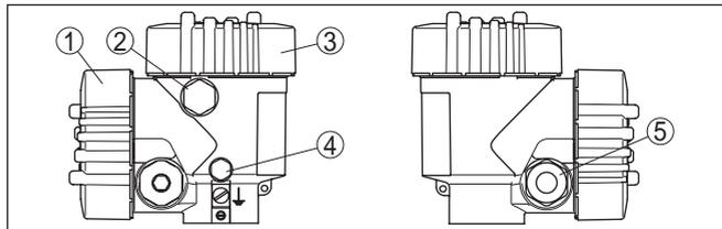
Abb. 25: Zweikammergehäuse
