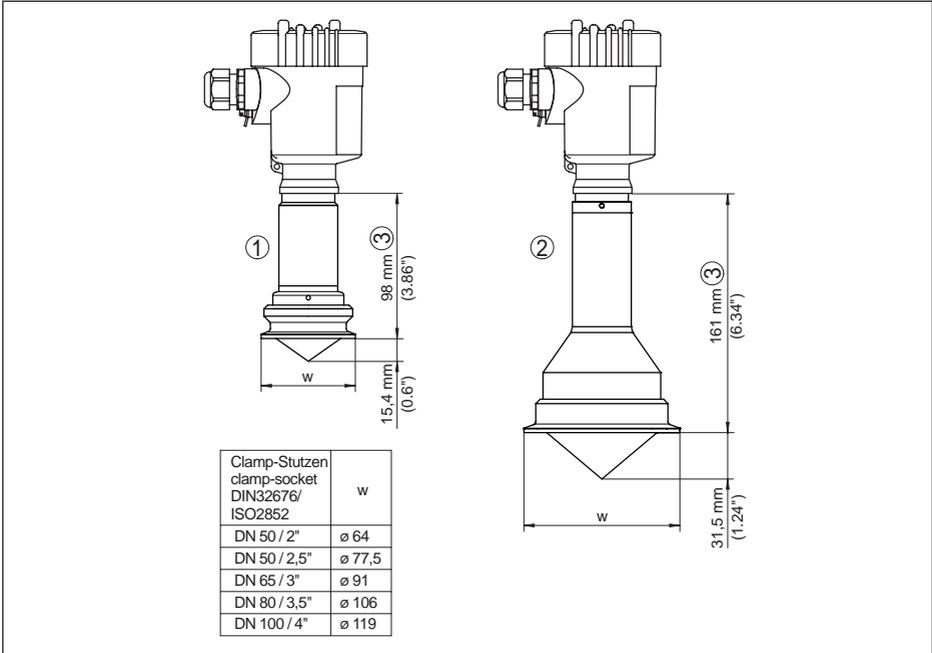
Abb. 47: VEGAPULS 63, Hygieneanschluss 2
