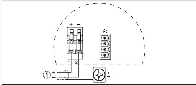
Abb. 24: Anschlussplan - Zweikammergehäuse
