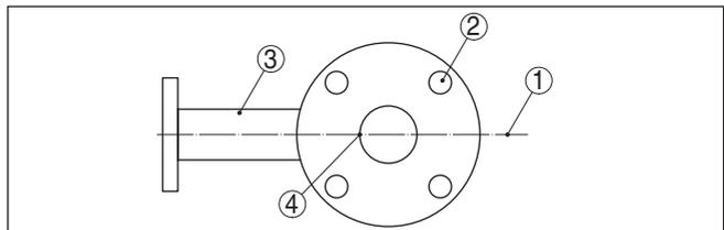
Abb. 16: Polarisationsebene bei Flanschausführung, von oben auf Sensor und Bypassrohr gesehen. Das Sensorgehäuse ist dabei nicht dargestellt.
