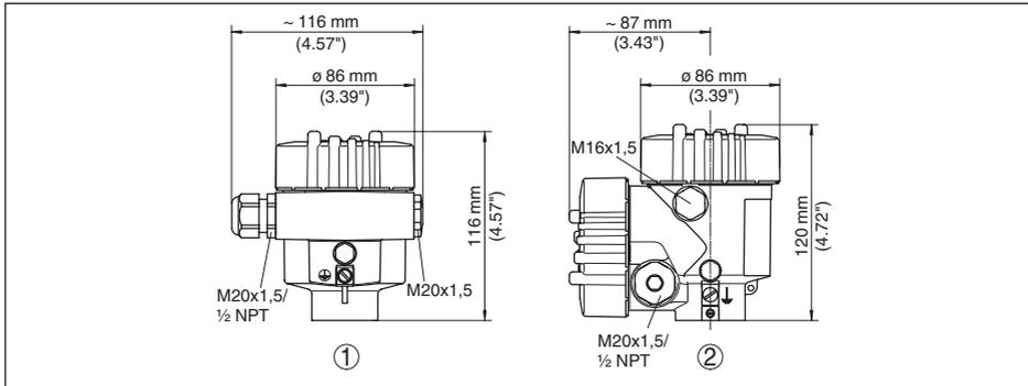
Abb. 40: Gehäuseausführungen in Schutzart IP 66/IP 68 (0,2 bar), (mit eingebautem Anzeige- und Bedienmodul vergrößert sich die Gehäusehöhe um 18 mm/0.71 in)
