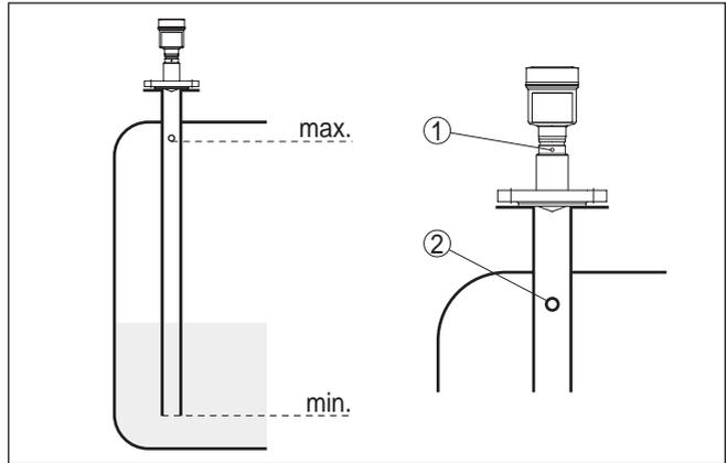
Abb. 14: Rohrantennensysteme im Tank. Die Entlüftungsbohrung im Schwallrohr muss in einer Ebene mit der Polarisationsmarkierung am Sensor liegen.
