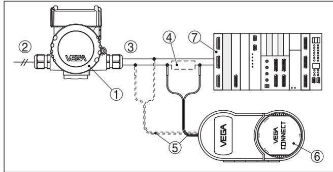
Abb. 27: Anschluss des PCs via HART an die Signalleitung
