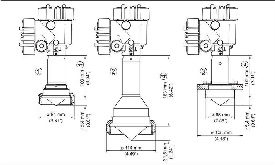
Abb. 37: VEGAPULS 63, Hygieneanschluss 4
