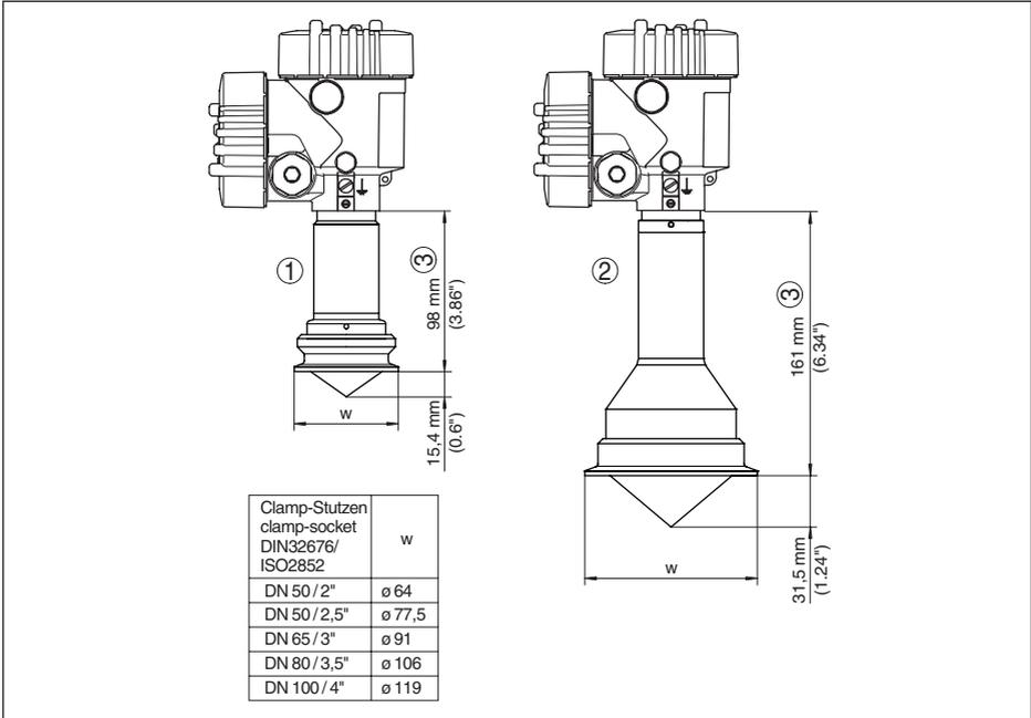
Abb. 35: VEGAPULS 63, Hygieneanschluss 2
