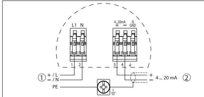
Abb. 21: Anschlussplan - Zweikammergehäuse
