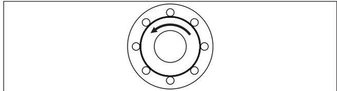
Abb. 10: VEGAPULS 63 - Losdrehen der PTFE-Scheibe
