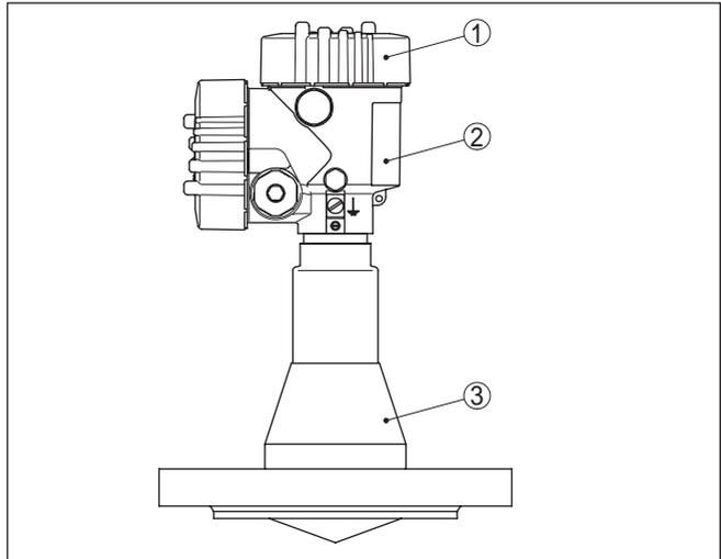
Abb. 1: VEGAPULS 63 - Flanschführung mit Aluminium-Zweikammergehäuse
