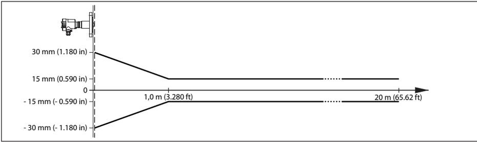
Abb. 30: Messabweichung VEGAPULS 63 mit erhöhter Empfindlichkeit in mm, Messbereich in m
