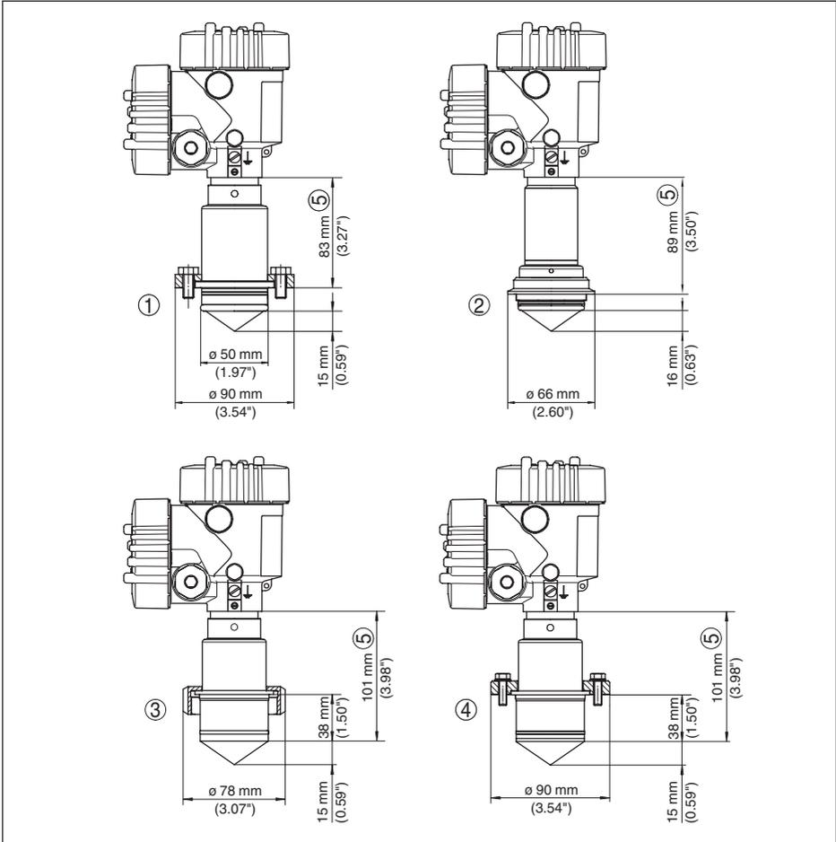
Abb. 34: VEGAPULS 63, Hygieneanschluss 1
