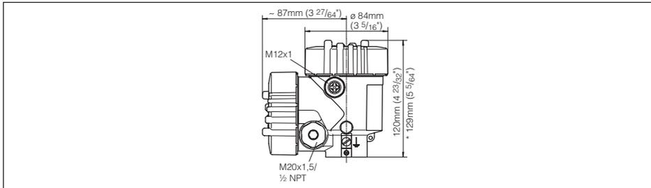
Abb. 31: Zweikammergehäuse (bei eingebautem Anzeige- und Bedienmodul vergrößert sich die Gehäusehöhe um 9 mm/0.35 in)
