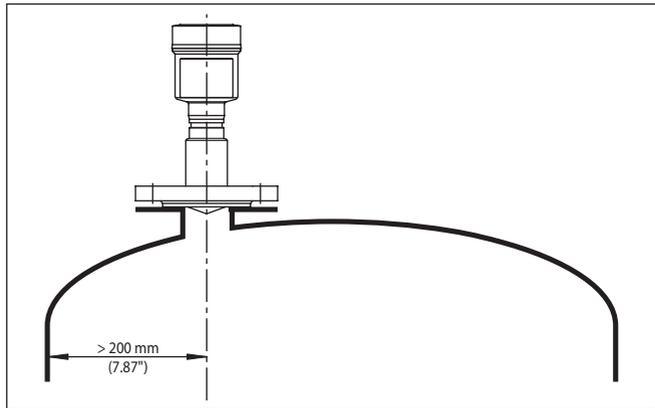
Abb. 5: Montage an runden Behälterdecken
