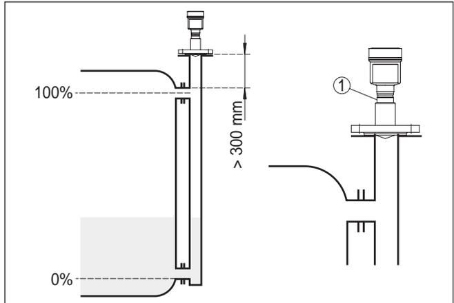
Abb. 15: VEGAPULS 63 in einem Bypassrohr. Die Polarisationsmarkierung am Prozessanschluss muss in einer Ebene mit den Rohrbohrungen oder den Rohranschlussöffnungen liegen.
