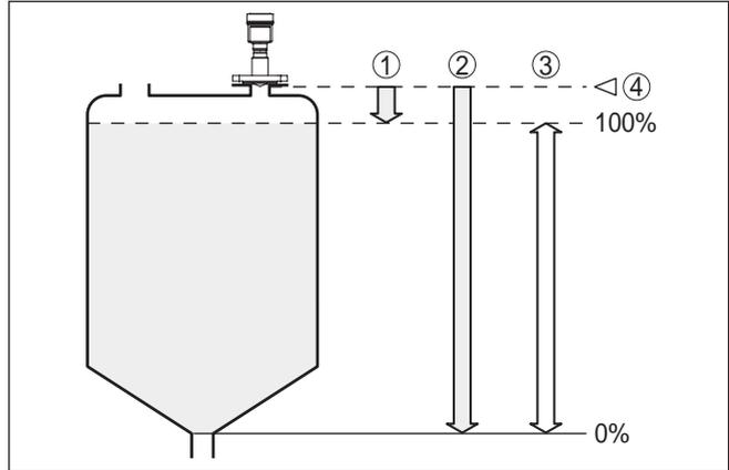
Abb. 3: Messbereich (Arbeitsbereich) und maximale Messdistanz
