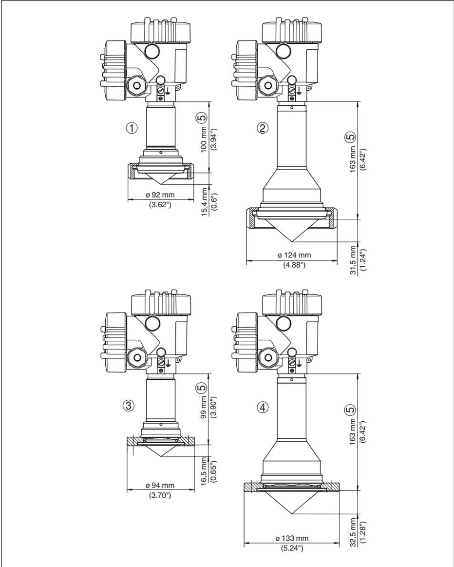
Abb. 36: VEGAPULS 63, Hygieneanschluss 3
