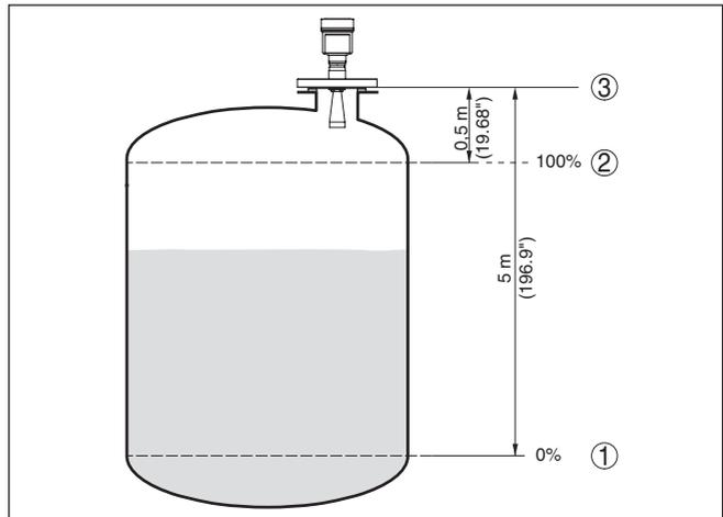
Abb. 24: Parametrierbeispiel Min.-/Max.-Abgleich
