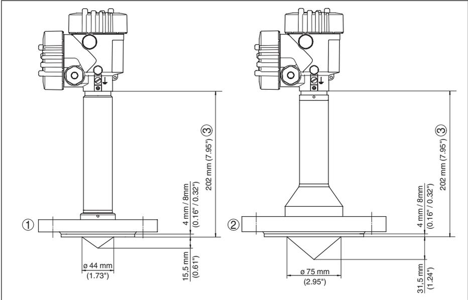
Abb. 33: VEGAPULS 63, Flanschausführung, Tieftemperatur
