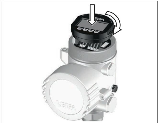
Abb. 18: Anzeige- und Bedienmodul einsetzen
