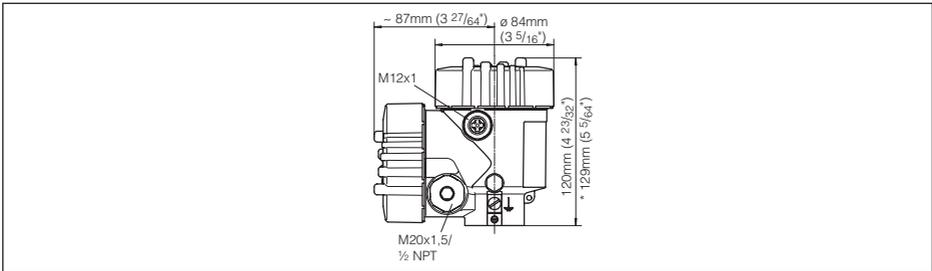
Abb. 26: Zweikammergehäuse aus Aluminium (bei eingebautem Anzeige- und Bedienmodul vergrößert sich die Gehäusehöhe um 9 mm/0.35 in)
