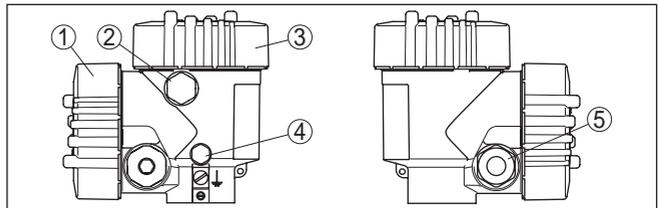
Abb. 14: Zweikammergehäuse
