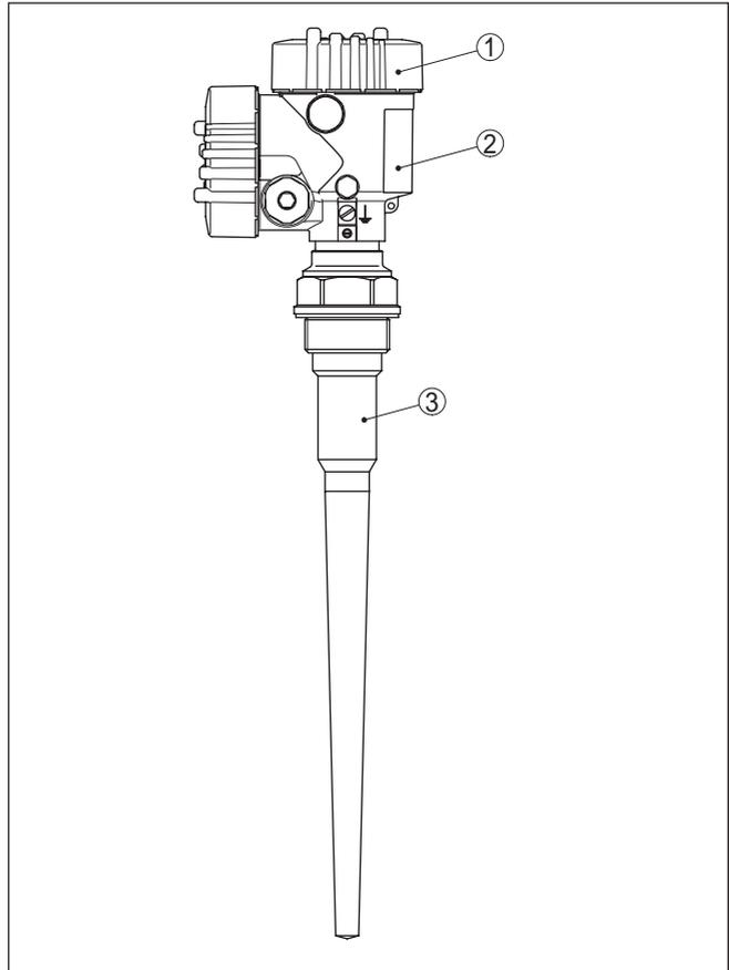
Abb. 1: VEGAPULS 65 - Gewindeausführung mit Aluminium-Zweikammergehäuse
