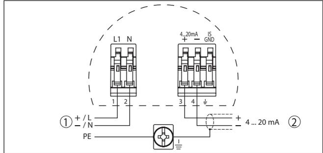
Abb. 17: Anschlussplan - Zweikammergehäuse
