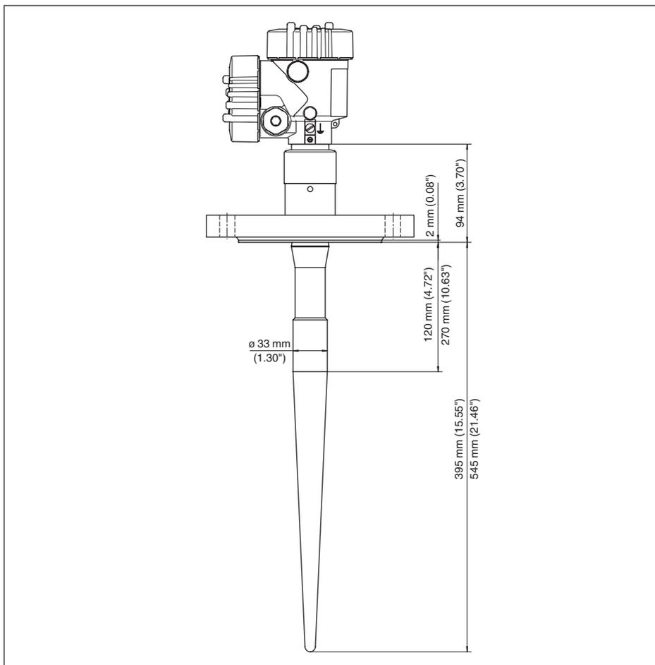
Abb. 28: VEGAPULS 65, Flanschausführung für Stutzen mit 100 mm Höhe (inaktive Länge 120 mm, 4 23/32") bzw. 250 mm Höhe (inaktive Länge 270 mm, 10 5/8")
