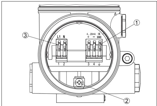
Abb. 16: Anschlussraum - Zweikammergehäuse
