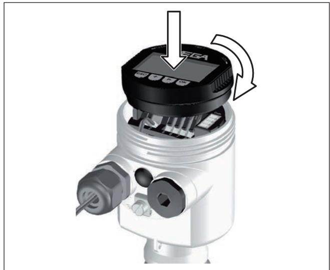
Abb. 30: Anzeige- und Bedienmodul einsetzen
