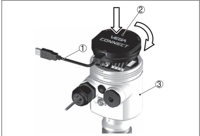
Abb. 36: Anschluss des PCs via VEGACONNECT direkt am Sensor
