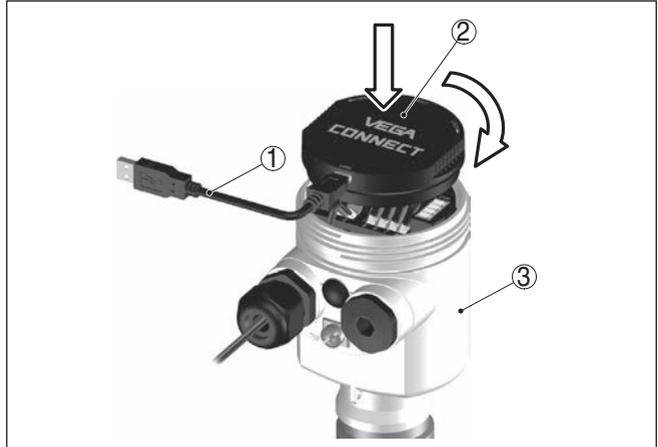
Abb. 34: Anschluss des PCs via VEGACONNECT direkt am Sensor
