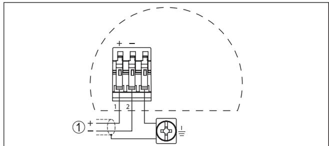
Abb. 24: Anschlussplan Ex-d-ia-Zweikammergehäuse
