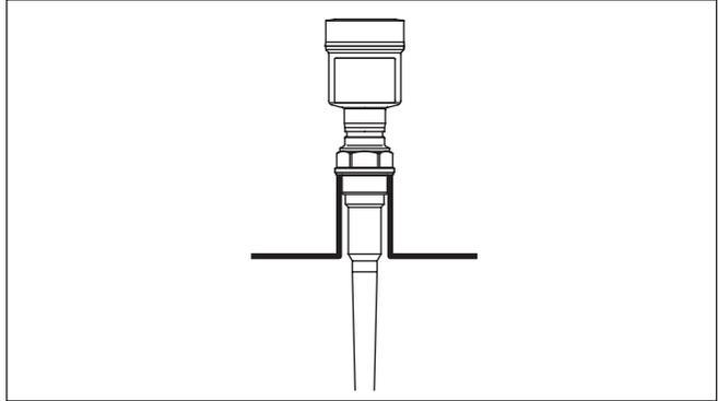
Abb. 9: Empfehlenswerte Rohrstützenmontage
