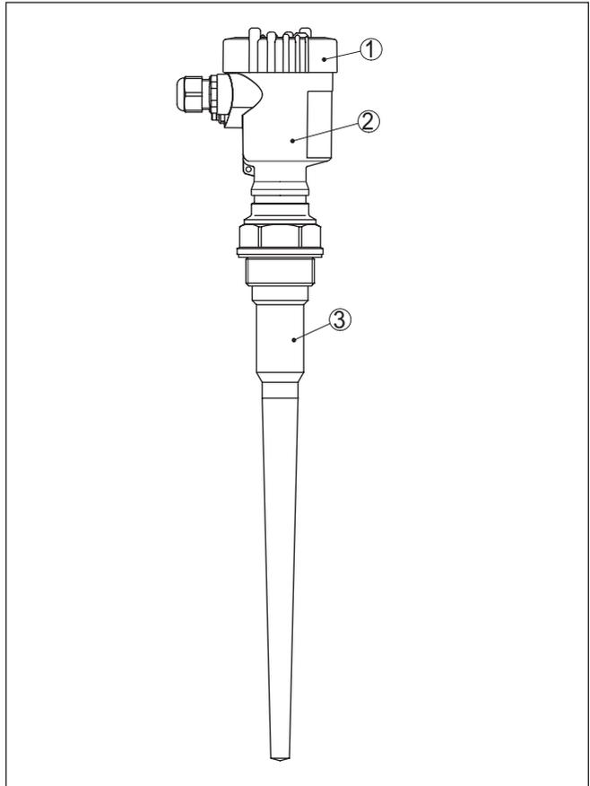
Abb. 1: VEGAPULS 65 - Gewindeausführung mit Kunststoffgehäuse
