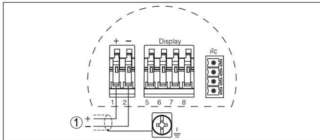
Abb. 16: Anschlussplan - Einkammergehäuse
