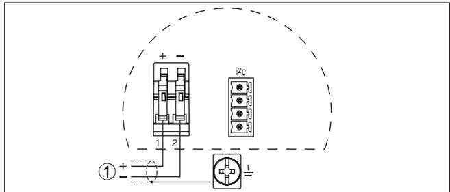
Abb. 20: Anschlussplan - Zweikammergehäuse
