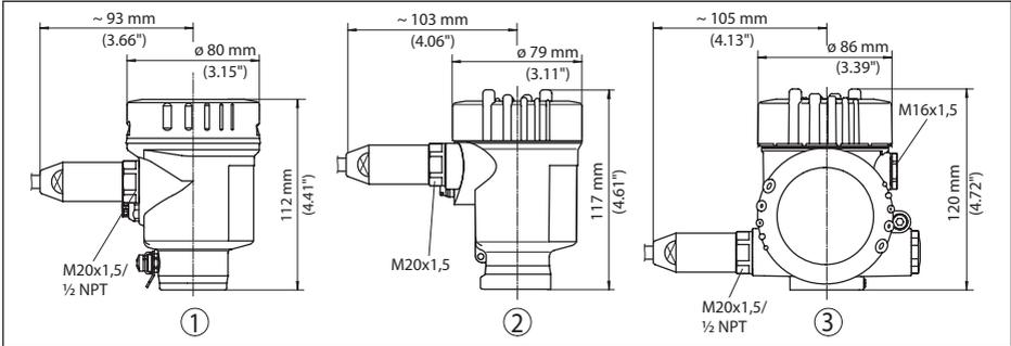
Abb. 39: Gehäuseausführungen in Schutzart IP 66/IP 68 (1 bar), (mit eingebautem Anzeige- und Bedienmodul vergrößert sich die Gehäusehöhe um 18 mm/0.71 in)
