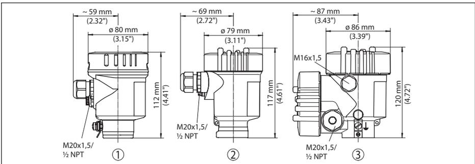
Abb. 38: Gehäuseausführungen in Schutzart IP 66/IP 68 (0,2 bar), (mit eingebautem Anzeige- und Bedienmodul vergrößert sich die Gehäusehöhe bei Position 1 um 9 mm/0.35 in, bei Position 2 und 3 um 18 mm/0.71 in)
