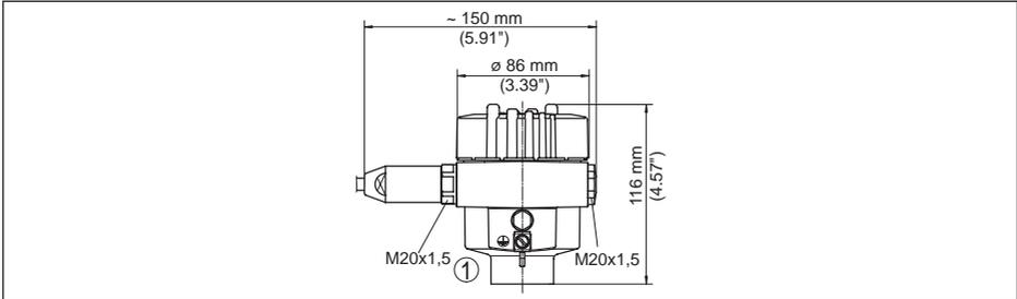
Abb. 37: Gehäuseausführungen in Schutzart IP 66/IP 68 (1 bar), (mit eingebautem Anzeige- und Bedienmodul vergrößert sich die Gehäusehöhe um 18 mm/0.71 in)
