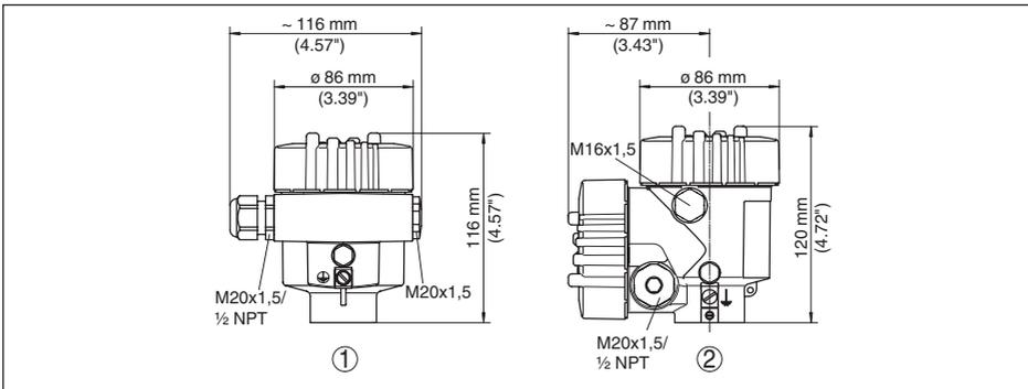
Abb. 36: Gehäuseausführungen in Schutzart IP 66/IP 68 (0,2 bar), (mit eingebautem Anzeige- und Bedienmodul vergrößert sich die Gehäusehöhe um 18 mm/0.71 in)
