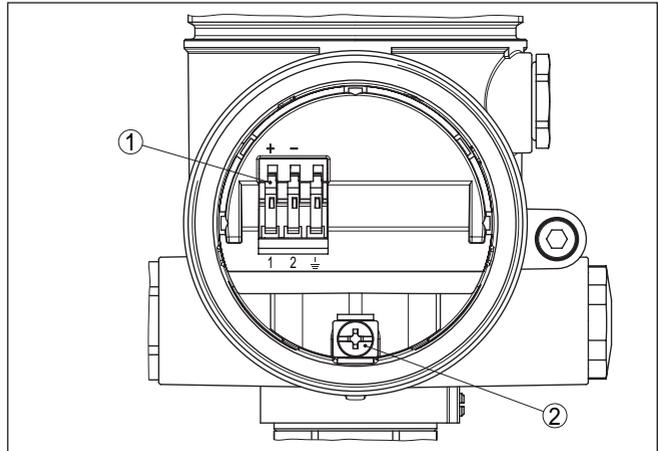
Abb. 23: Anschlussraum Ex-d-ia-Zweikammergehäuse
