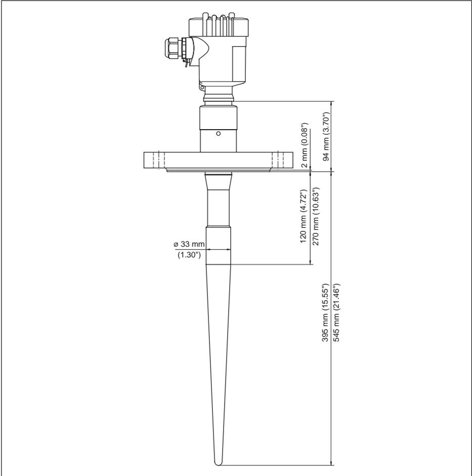
Abb. 41: VEGAPULS 65, Flanschausführung für Stutzen mit 100 mm Höhe (inaktive Länge 120 mm, 4 23/32") bzw. 250 mm Höhe (inaktive Länge 270 mm, 10 5/8")
