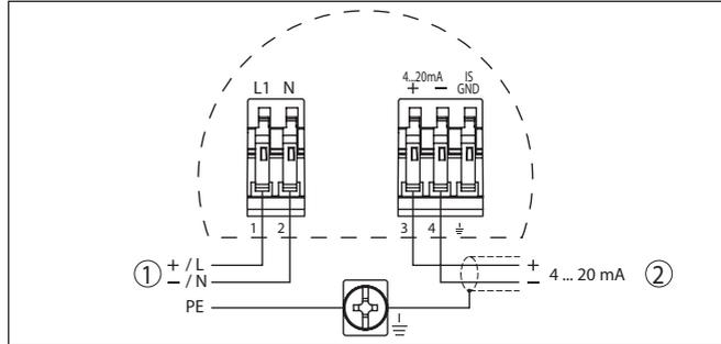
Abb. 10: Anschlussplan - Zweikammergehäuse
