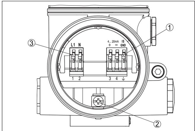
Abb. 9: Anschlussraum - Zweikammergehäuse
