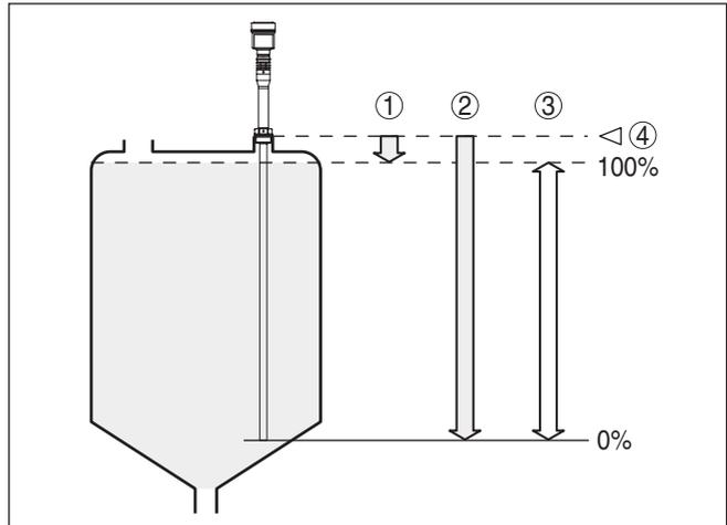
Abb. 3: Messbereich (Arbeitsbereich) und maximale Messdistanz
