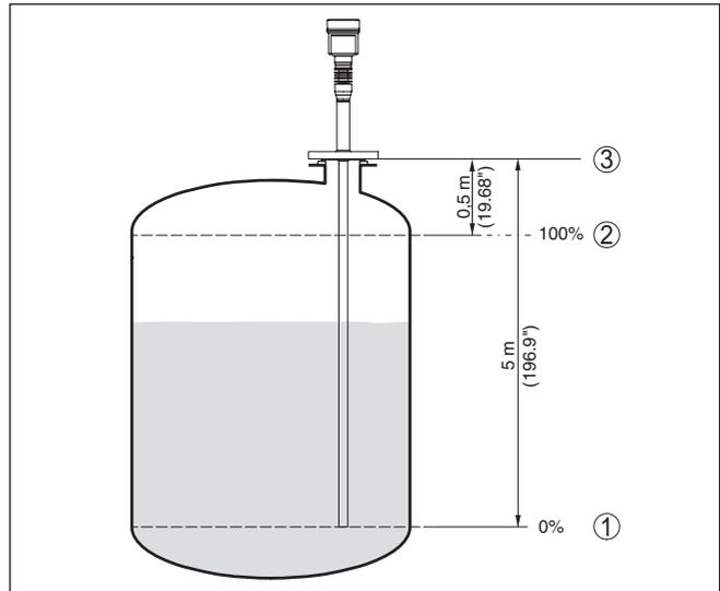
Abb. 13: Parametrierbeispiel Min.-/Max.-Abgleich
