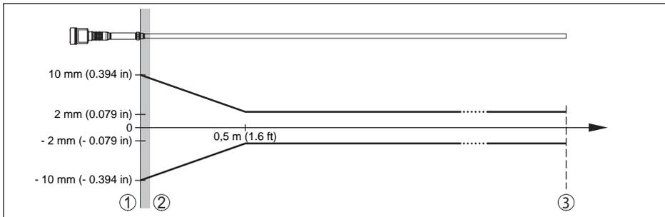
Abb. 18: Messabweichung VEGAPULS 62 Standrohr
