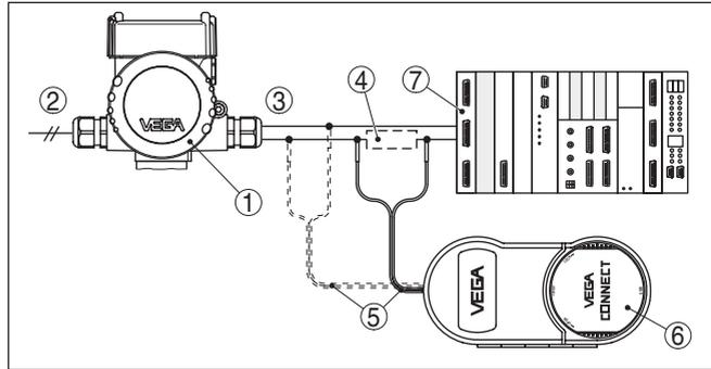
Abb. 16: Anschluss des PCs via HART an die Signalleitung
