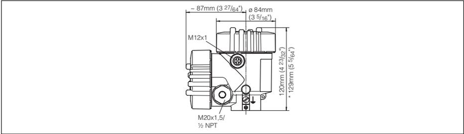
Abb. 19: Zweikammergehäuse (bei eingebautem Anzeige- und Bedienmodul vergrößert sich die Gehäusehöhe um 9 mm/0.35 in)
