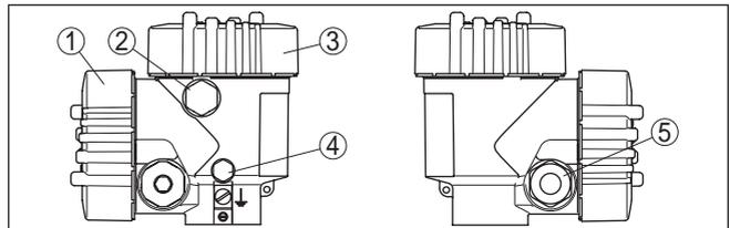
Abb. 7: Zweikammergehäuse
