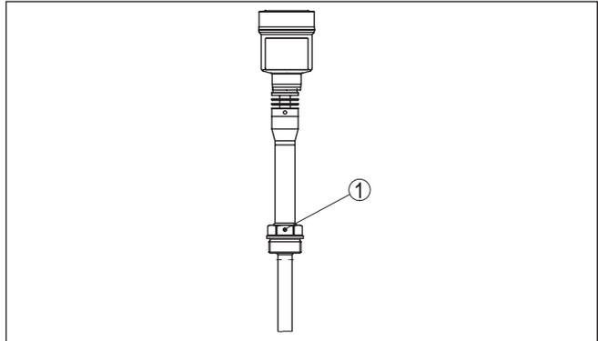
Abb. 4: Lage der Polarisationssebene beim Radarsensor mit Standrohrantenne
