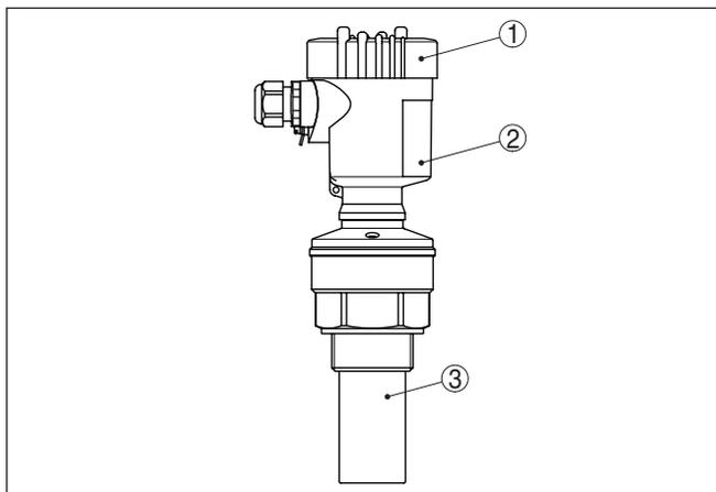
Figura 1: VEGASON 61, esecuzione con custodia di resina
