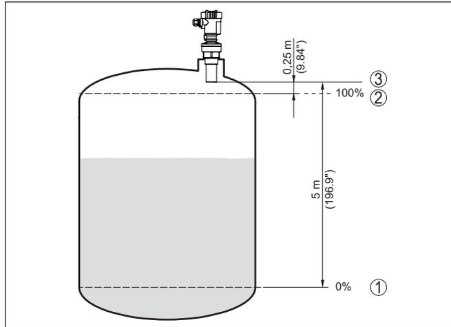
Figura 29: Esempio di parametrizzazione Taratura di min./max.
