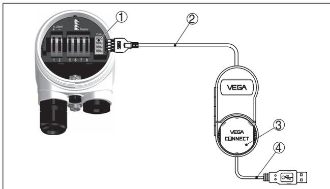
Figura 31: Allacciamento tramite adattatore d'interfaccia VEGACONNECT esterno
