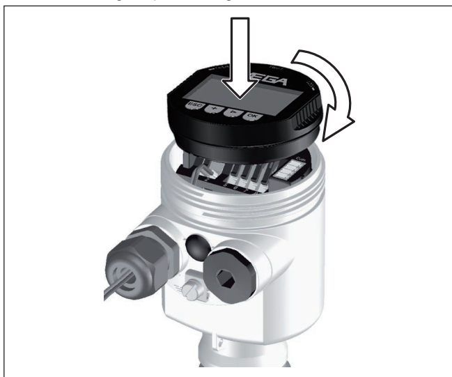
Fig. 26: Display- en bedieningsmodule in de eenkamerbehuizing plaatsen
