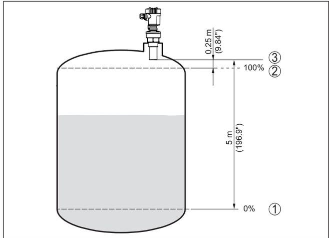
Abb. 29: Parametrierbeispiel Min./Max.-Abgleich
