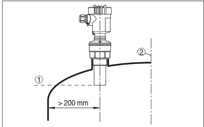
Abb. 5: Montage an runden Behälterdecken
