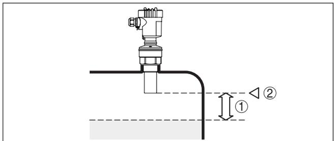
Abb. 3: Blockdistanz zur max. Füllhöhe
