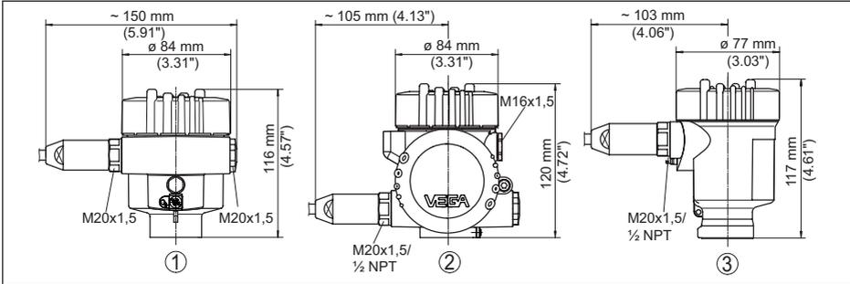
Abb. 36: Gehäuseausführungen in Schutzart IP66/IP68 (1 bar), (mit eingebautem Anzeige- und Bedienmodul vergrößert sich die Gehäusehöhe um 18 mm/0.71 in)
