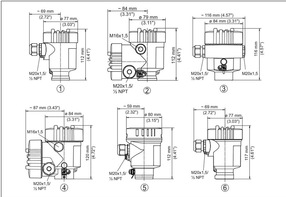
Abb. 35: Gehäuseausführungen in Schutzart IP66/IP68 (0,2 bar), (mit eingebautem Anzeige- und Bedienmodul vergrößert sich die Gehäusehöhe um 9 mm/0.35 in, bei Metallgehäusen um 18 mm/0.71 in)
