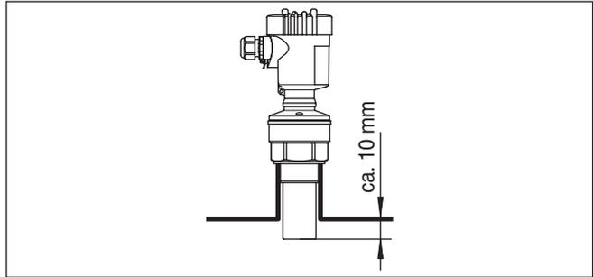
Abb. 7: Empfehlenswerte Rohrstützenmontage
