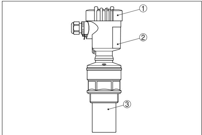
Abb. 1: VEGASON 62, Gewindeausführung mit Kunststoffgehäuse
