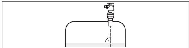
Abb. 9: Ausrichtung in Flüssigkeiten
