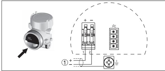
Abb. 24: Anschlussplan - Zweikammergehäuse
