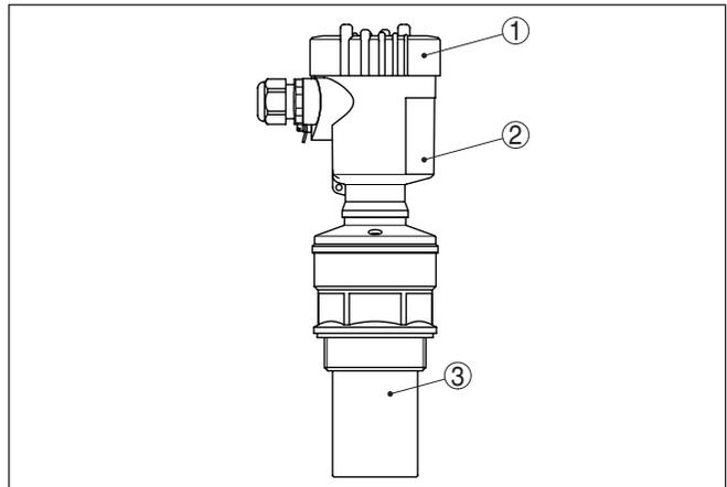
Abb. 1: VEGASON 62, Gewindeausführung mit Kunststoffgehäuse
