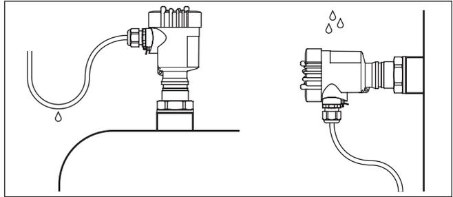
Abb. 2: Maßnahmen gegen das Eindringen von Feuchtigkeit
