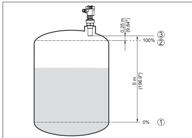
Abb. 29: Parametrierbeispiel Min.-/Max.-Abgleich
