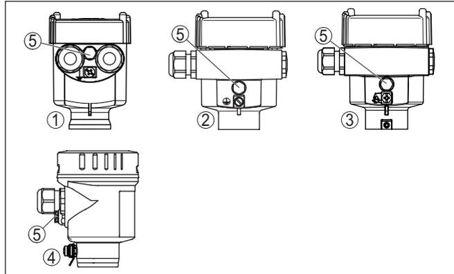
Abb. 19: Werkstoffvarianten Einkammergehäuse
