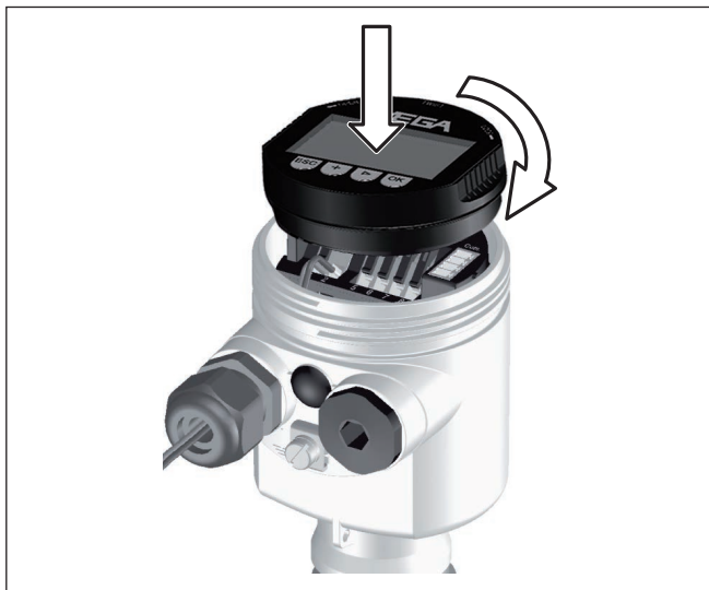
Fig. 26: Display- en bedieningsmodule in de eenkamerbehuizing plaatsen
