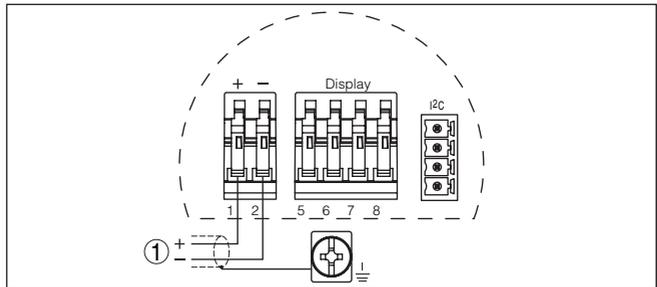
Figura 18: Schema di allacciamento - custodia a una camera
