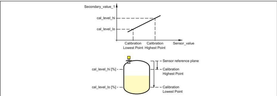
Figura 33: Taratura VEGASON 61
