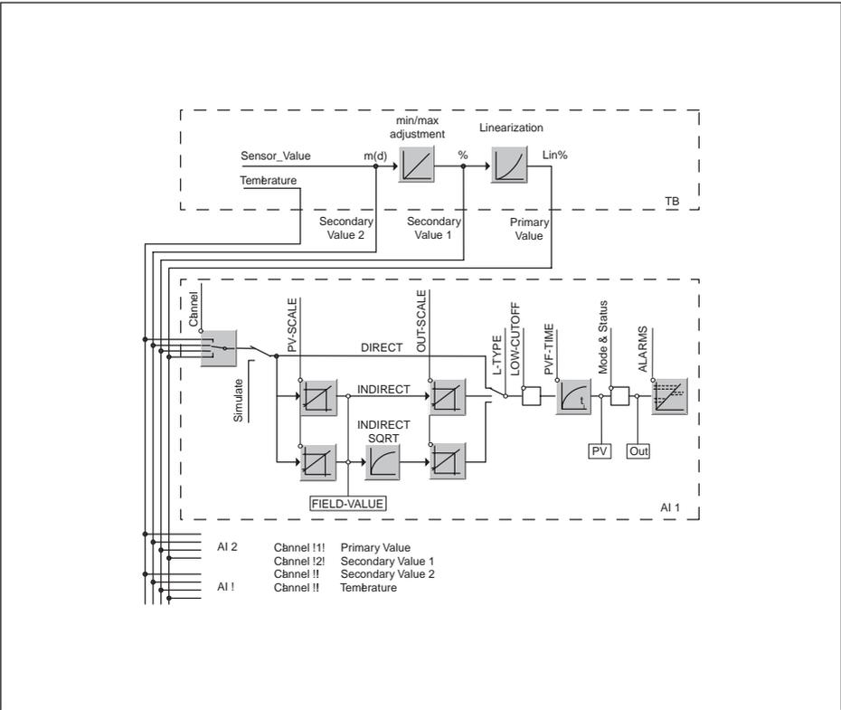
Figura 32: Elaborazione valore di misura VEGASON 61
