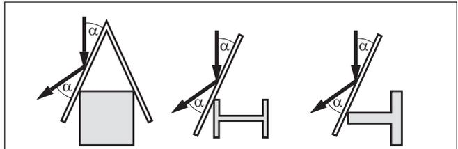
Figura 11: Copertura di profili piatti mediante deflettori
