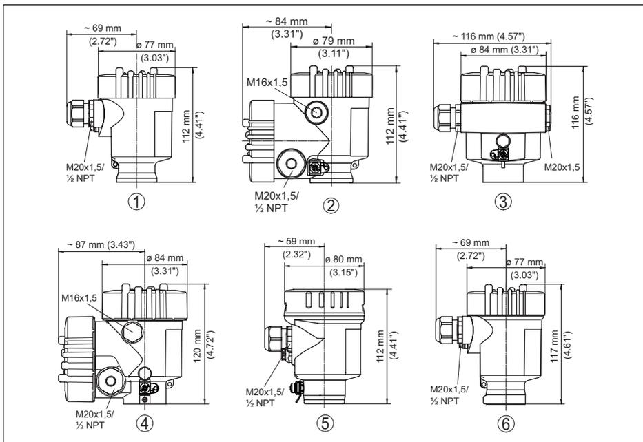
Figura 34: Differenti custodie con grado di protezione IP66/IP68 (0,2 bar), (con tastierino di taratura con display incorporato l'altezza della custodia aumenta di 9 mm/0.35 in, in caso di custodie di metallo di 18 mm/0.71 in)
