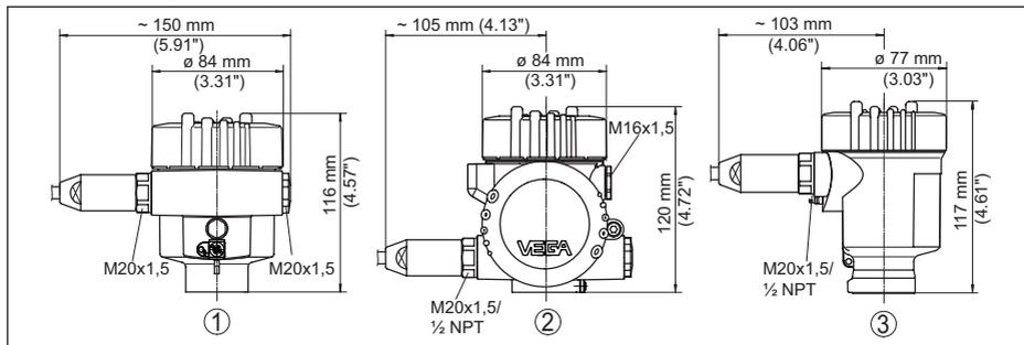
Figura 35: *Differenti custodie con grado di protezione IP66/IP68 (1 bar), (con tastierino di taratura con display incorporato l'altezza della custodia aumenta di 18 mm/0.71 in)*
