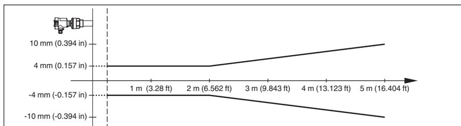
Figura 31: Scostamento di misura VEGASON 61
