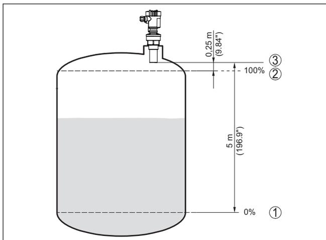
Figura 27: Esempio di parametrizzazione Taratura di min./max.
