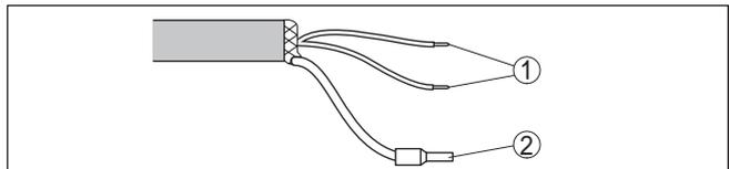
Figura 23: Assegnazione dei conduttori del cavo di collegamento
