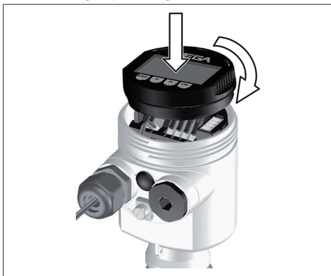
Fig. 24: Display- en bedieningsmodule in de eenkamerbehuizing plaatsen
