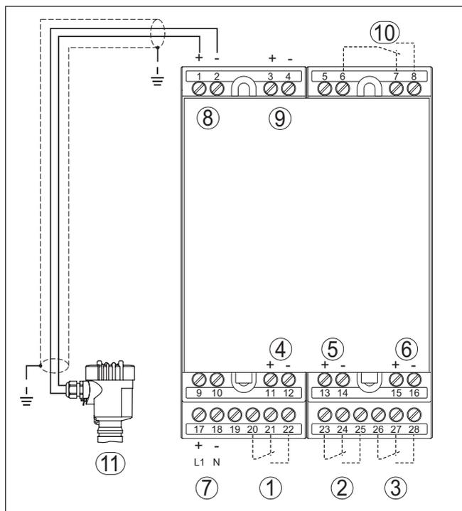
Figura 3: Schema di allacciamento VEGAMET 624 con sensore bifilare
