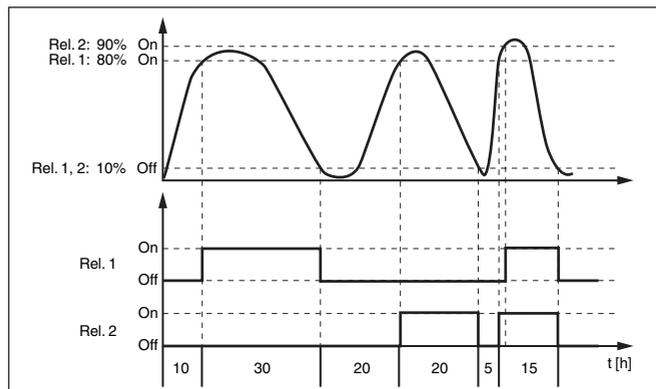
Figura 12: Esempio di un controllo di pompe 2
