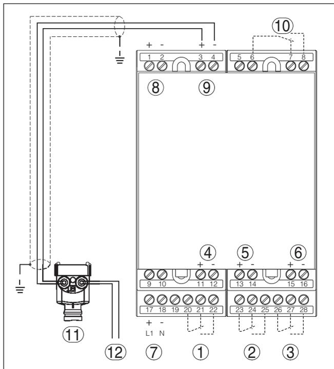
Figura 4: Schema di allacciamento VEGAMET 624 con sensori quadrifilari
