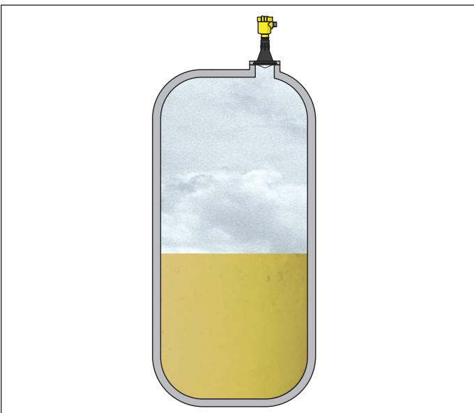
插图. 26: 用 VEGAPULS 61 在一个酸槽中测量液位
