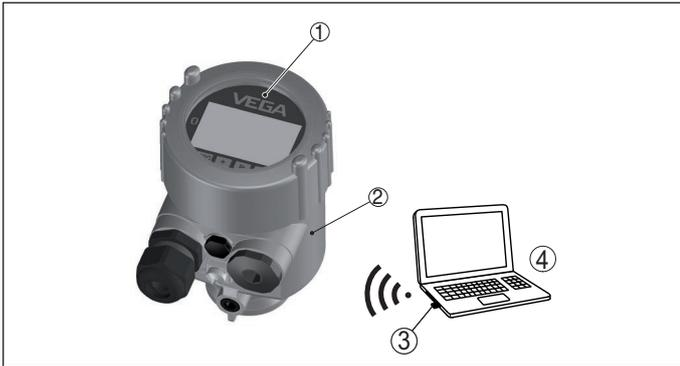
Fig. 47: Conexión del PC mediante adaptador USB Bluetooth
