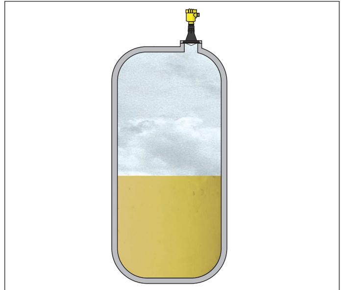
Fig. 26: Medición de nivel en un tanque de ácido con VEGAPULS 61
