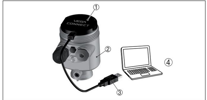
Fig. 45: Conexión del PC vía VEGACONNECT y USB
