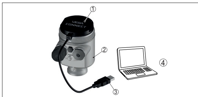
插图. 27: 通过 VEGACONNECT 和 USB 与电脑连接
