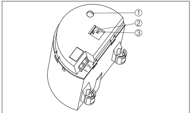
Fig. 10: Électronique SWE60C - sortie statique
