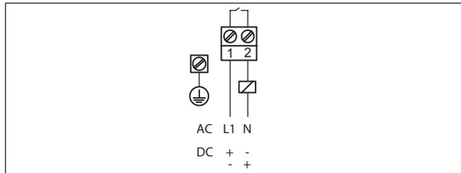
Fig. 9: Schéma de raccordement boîtier à chambre unique
