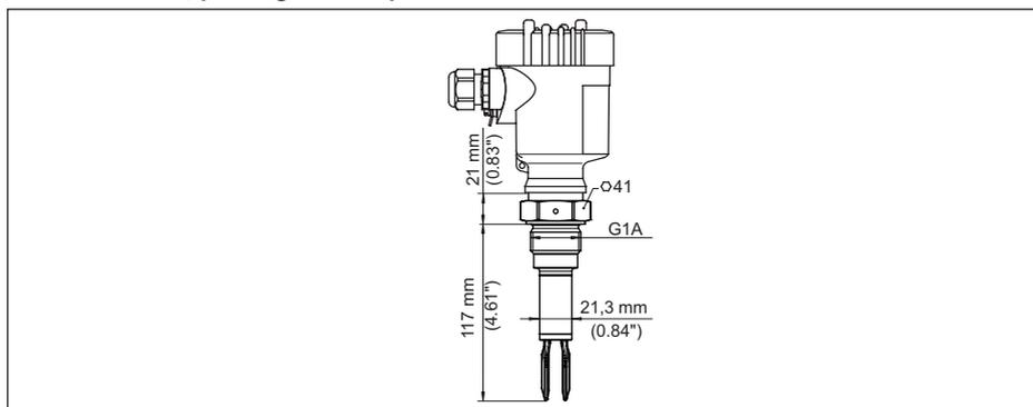
Fig. 22: Prolongation du point de commutation - pour le remplacement facile d'un VEGASWING 81 ou 81 A
