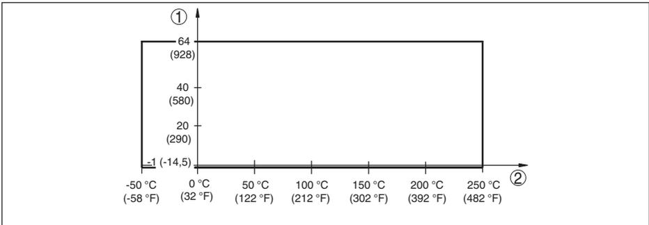
Fig. 16: Température process - pression process avec position du commutateur  $\geq 0,7 \text{ g/cm}^3$  (commutateur d'inversion de la sensibilité)
