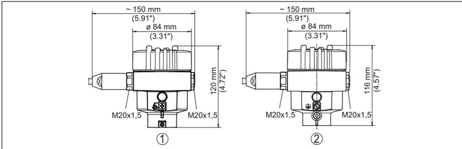
Fig. 19: Variantes de boîtier en protection IP66/IP68 (1 bar)
