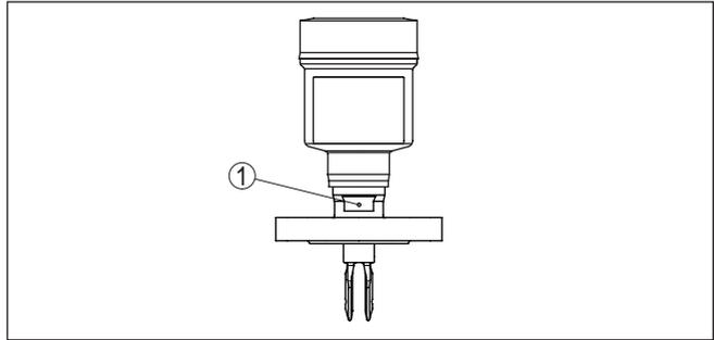
Fig. 5: Position des lames avec versions à bride
