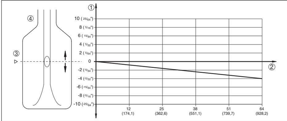
Fig. 14: Influence de la pression process sur le point de commutation
