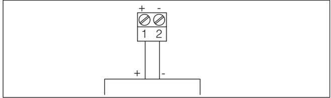
Fig. 9: Schéma de raccordement boîtier à chambre unique
