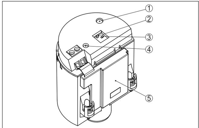
Fig. 11: Électronique SWE60N - sortie NAMUR
