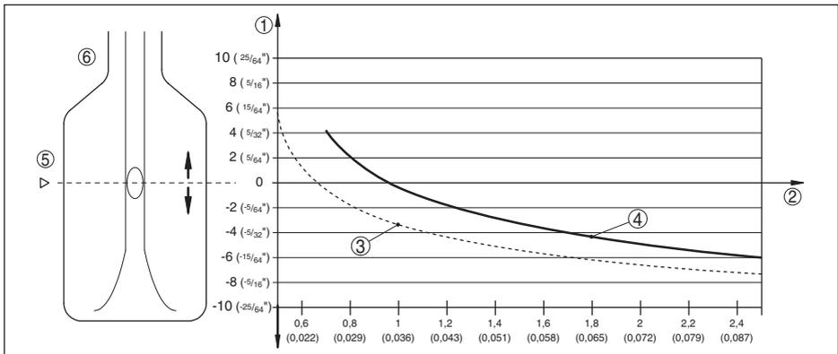
Fig. 13: Influence de la densité du produit sur le point de commutation
