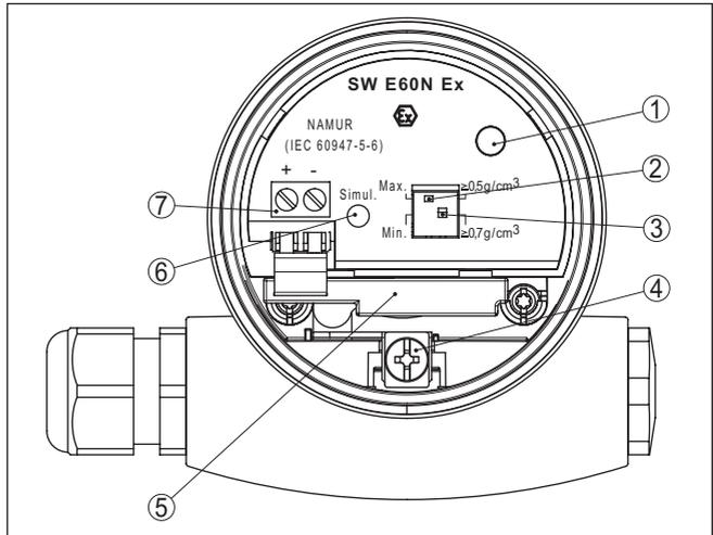
Fig. 8: Compartiment électronique et de raccordement de boîtier à chambre unique
