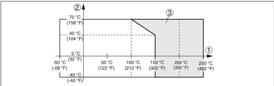
Fig. 15: Température ambiante - température process
