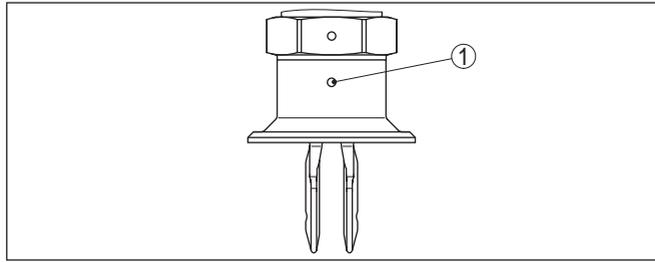
Fig. 6: Marquage sur le raccord à souder
