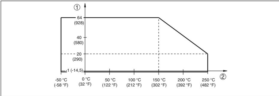
Fig. 17: Température process - pression process avec position du commutateur  $\geq 0,5 \text{ g/cm}^3$  (commutateur d'inversion de la sensibilité)
