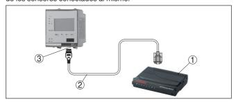
Fig. 8: Conexión del módem por RS232
