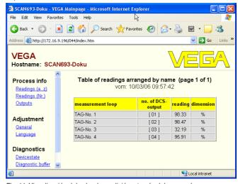
Fig. 11: Visualización del valor de medición a través del navegador
