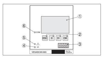
Fig. 5: Elementos de indicación y ajuste
