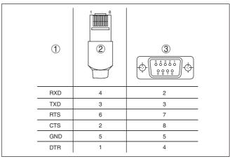
Fig. 10: Configuración de pines del cable de conexión al módem RS232
