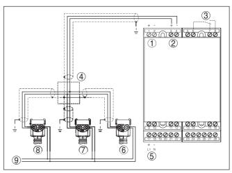
Fig. 4: Ejemplo de conexión VEGASCAN 693 con sensores de cuatro hilos
