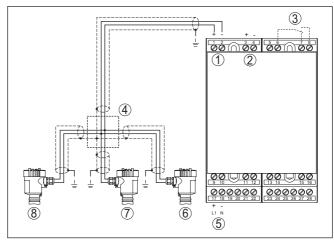
Fig. 3: Ejemplo de conexión VEGASCAN 693 con sensores de dos hilos
