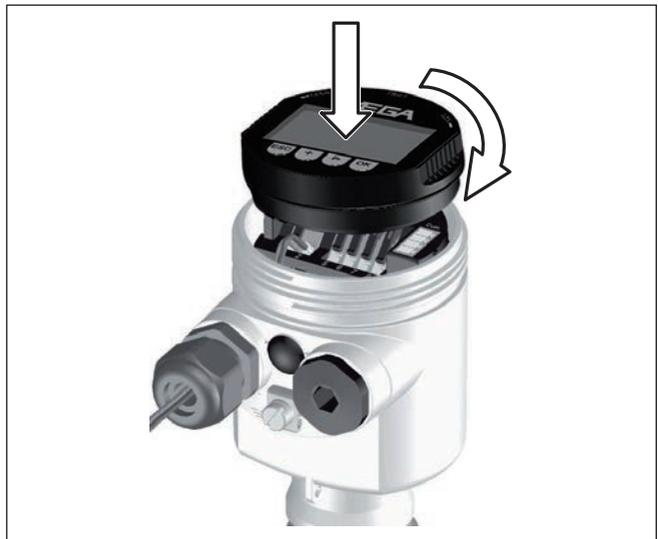
Abb. 32: Anzeige- und Bedienmodul einsetzen
