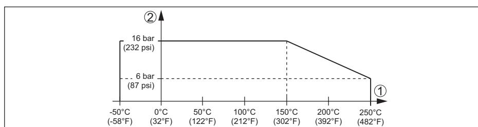
插图. 13: 过程压力 - 过程温度
