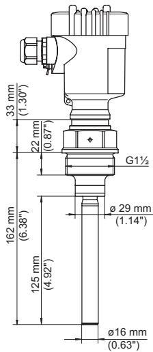
插图. 17: VEGA VIB 61 , 螺纹型 G1½ (DIN ISO 228/1)
