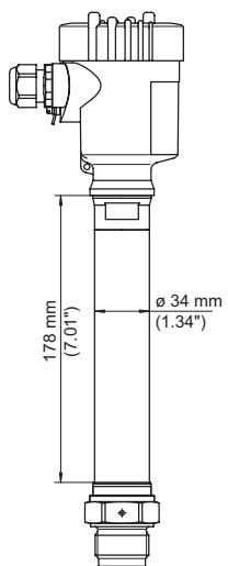
插图. 18: 温度连接元件
