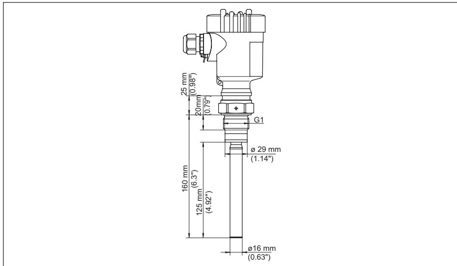
插图. 16: VEGAVIB 61, 螺纹型 G1 (DIN ISO 228/1)
