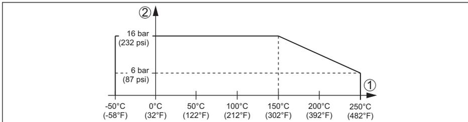
Abb. 16: Prozessdruck - Prozesstemperatur
