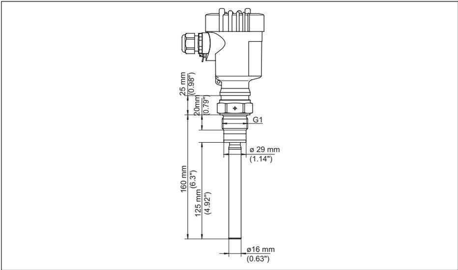
Abb. 20: VEGAVIB 61, Gewindeausführung G1 (DIN ISO 228/1)
