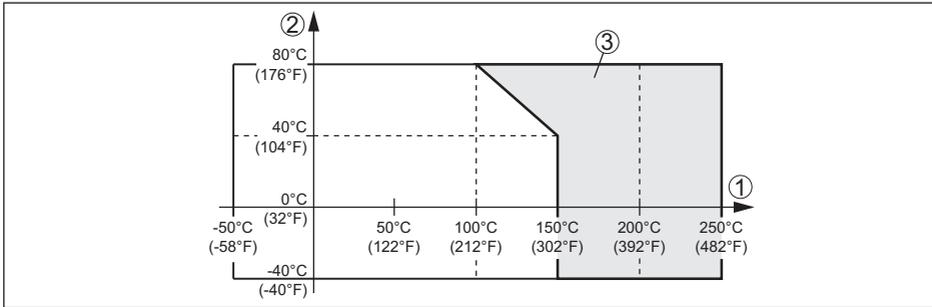
Abb. 17: Umgebungstemperatur - Prozesstemperatur
