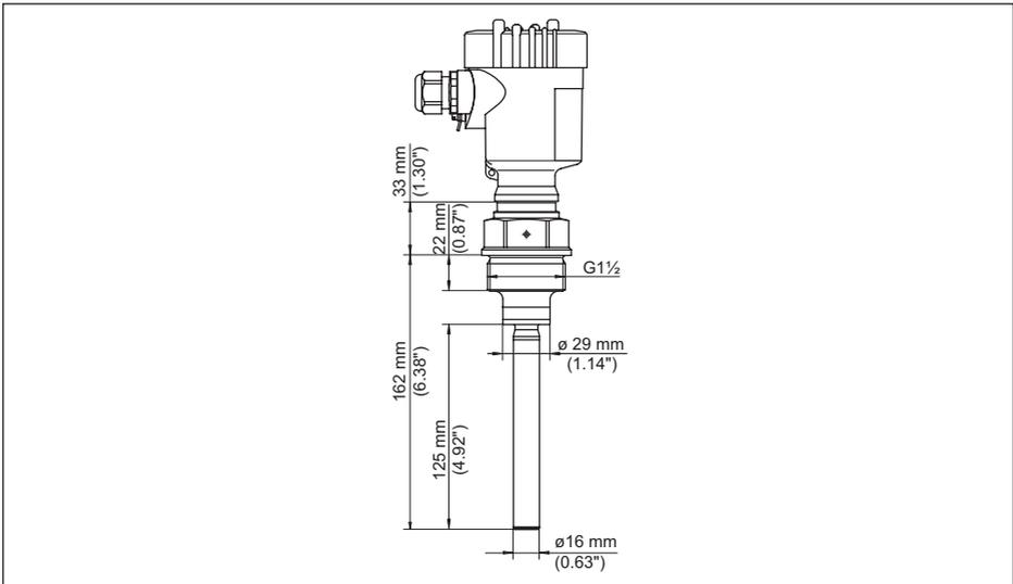
Abb. 21: VEGAVIB 61, Gewindeausführung G1½ (DIN ISO 228/1)
