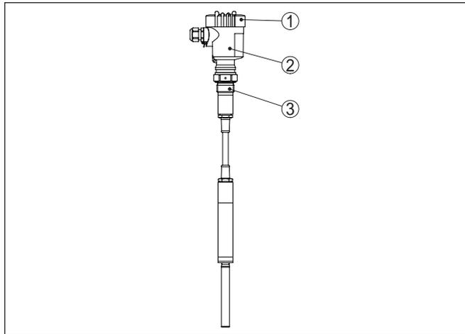
Figura 1: VEGAVIB 62 con custodia di resina
