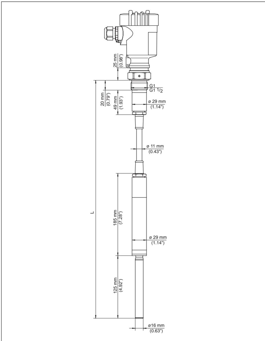
Figura 29: VEGAVIB 62 con cavo portante PUR
